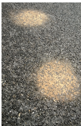
Abb. 10: Gleichmässig verteilter Sand auf Belag für Messung der Makrotexturtiefe nach SN 640 511-1.
