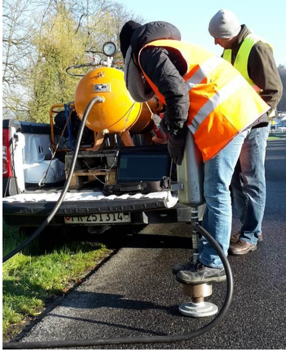
Abb. 9: Luftpermeabilitätsverfahren entwickelt von Weibel AG.
