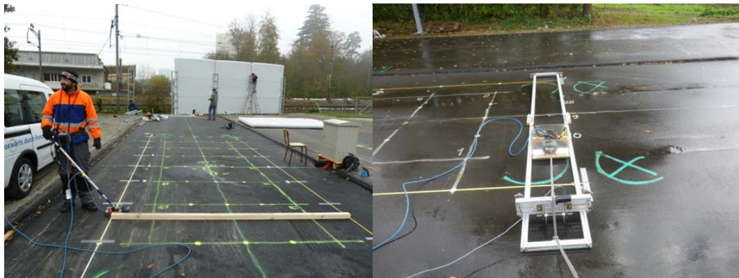
Abb. 53 Radarantenne auf dem Messfeld, Messkampagne vom 16.04.13 (links) und angepasste Messapparatur, Messkampagne vom 18.11.13 (rechts)
