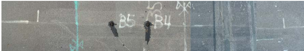
Abb. 90 Visueller Zustand der Belagsoberfläche nach 300'000 Überrollungen
