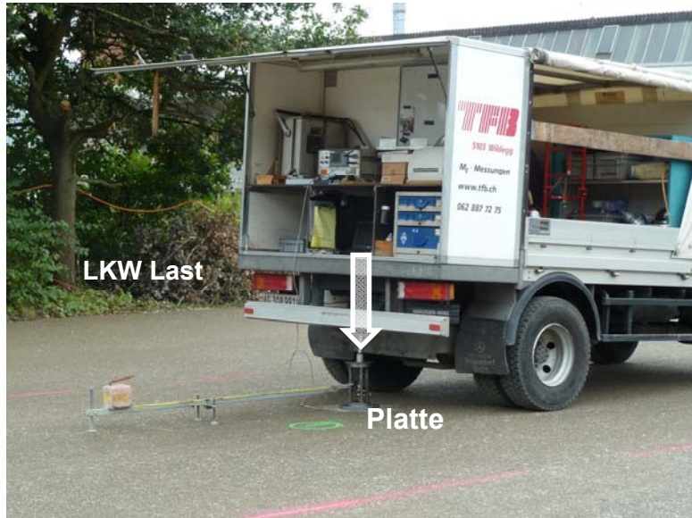
Abb. 16 Plattendruckversuch auf der Planie des Testfeldes
