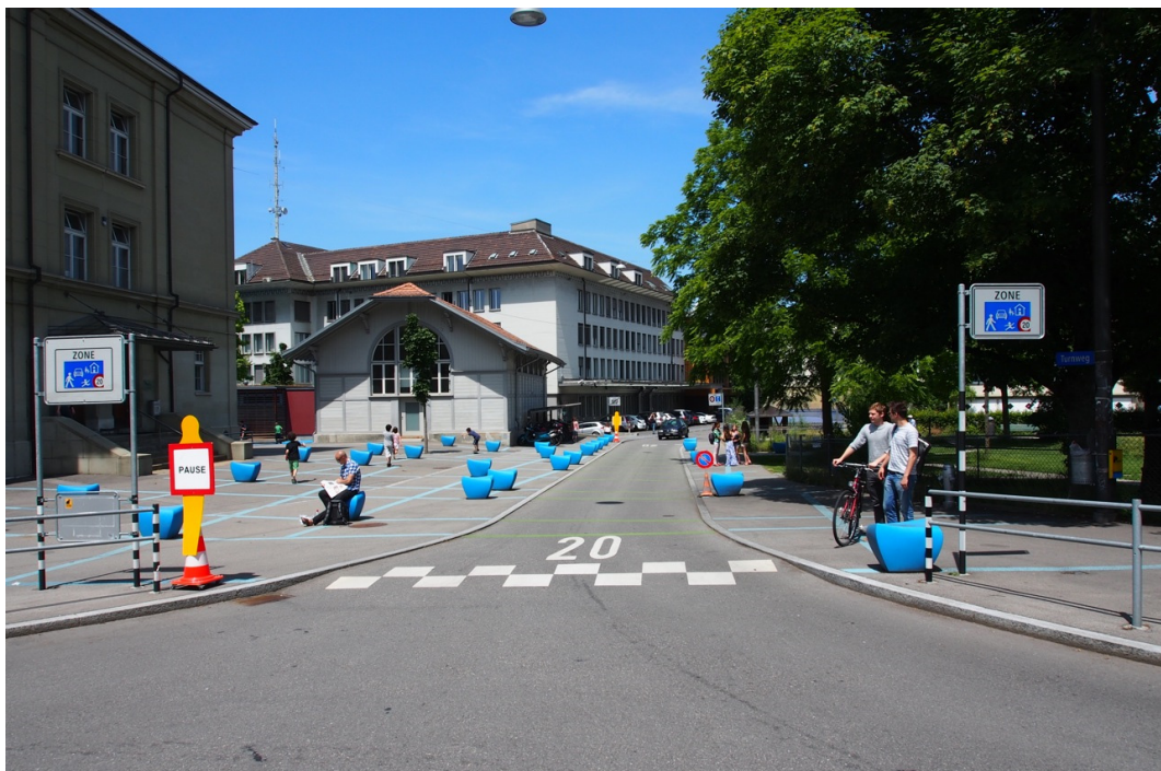
Abbildung 78 Bern Turnweg: Eine Begegnungszone schützt den Bereich zwischen Pausenplatz und Schulhaus (links im Bild) und dem Spiel- und Sportplatz (rechts im Bild hinter den Bäumen). Die auffälligen blauen Kunststoffelemente dienen als Sitzgelegenheit und verhindern das wilde Parkieren und führen zu einem hohen Zonenbewusstsein. (Archivbild verkehrsteiner AG)
