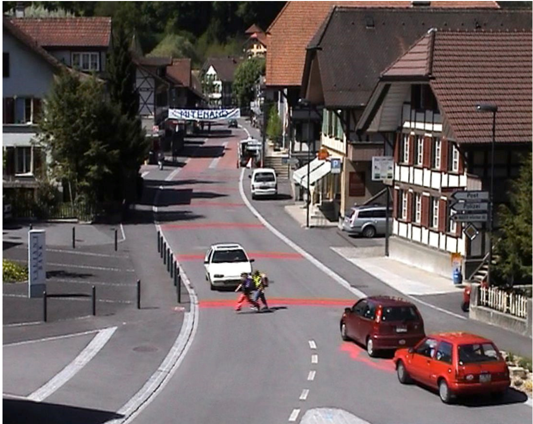
Abbildung 88 Neuenegg BE: Kinder queren die Strasse vor freiwillig haltenden Fahrzeugen. Früher waren hier drei Fussgängerstreifen markiert. Die meisten Zufussgehenden querten aber abseits entlang ihrer Wunschlinie. Nach intensiver Öffentlichkeitsarbeit (Flyer an Autofahrende abgeben, Plakate, Transparente etc.) nach Einführung hat sich das neue Regime gut eingespielt. (Archivbild verkehrsteiner AG)
