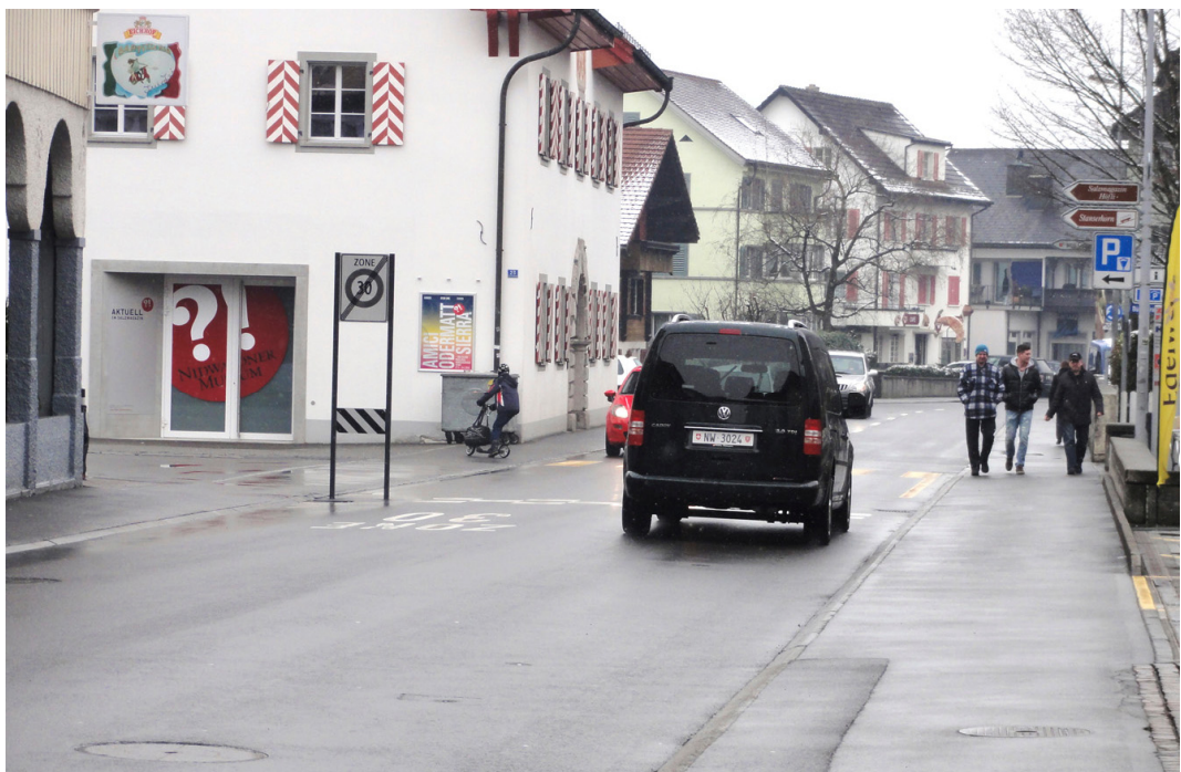
Abbildung 8 Eingangstor in die neue Tempo-30-Zone auf der Ortsdurchfahrt von Stans (Archivbild verkehrsteiner AG, 2012)
