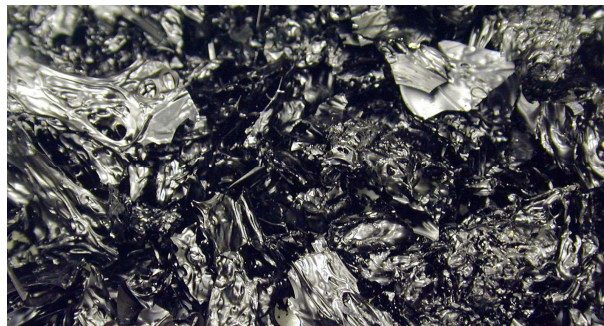
Fig. 4 Photo du liant récupéré du RAP 0/11 réchauffé 16 h à 160°C.
