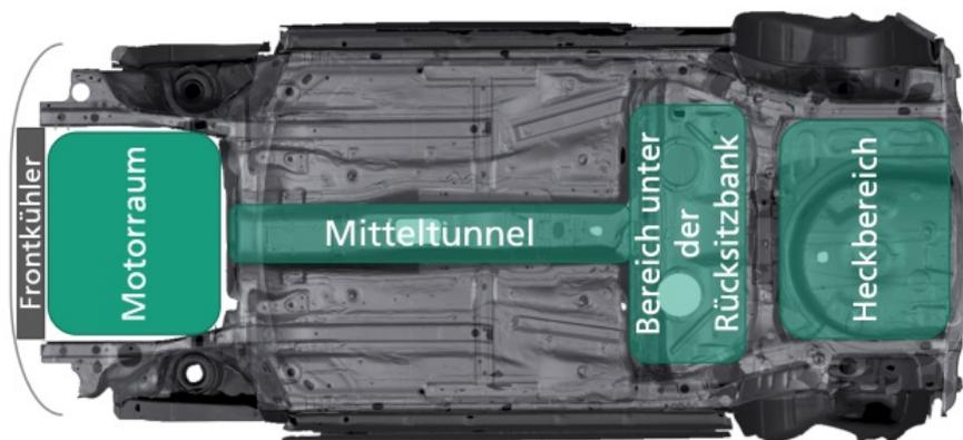
Abbildung 4: Verfügbare Bauräume, dargestellt an einer Draufsicht auf den Karosserieboden
