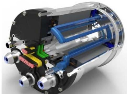
Abbildung 9: Schnittbild zum Elektromotor
