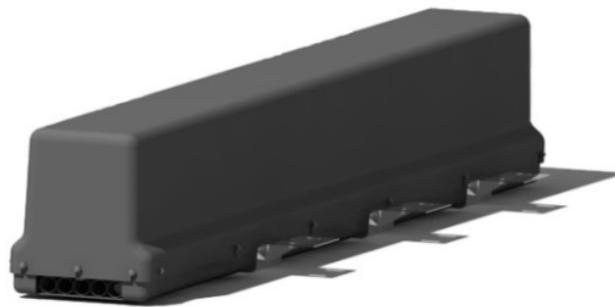
Abbildung 12: Batteriegehäuse für fünf Module im Mitteltunnel
