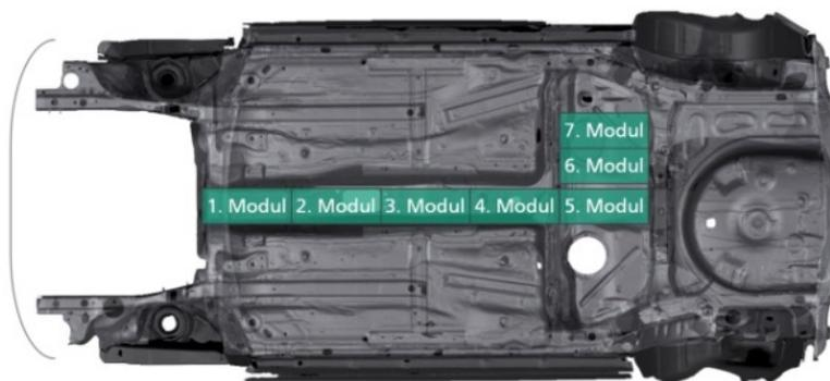
Abbildung 11: Anordnung der Batteriemodule, Karosserieunterboden
