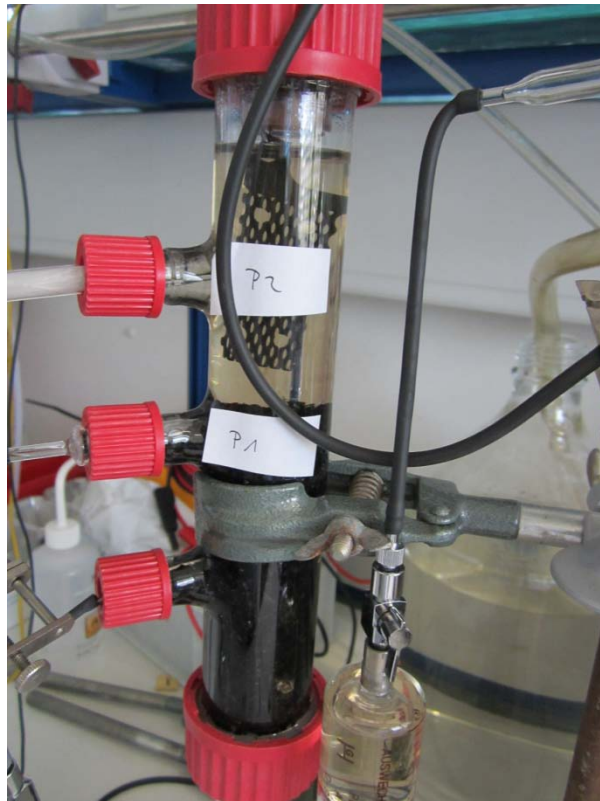
Abbildung 79: Foto der Durchflusszelle nach Entfernung des auf der A-Kohle angebrachten Geoflieses.
