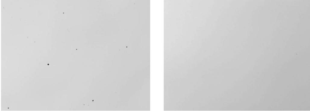
Abbildung 59: **Links:** Mikroskopaufnahme einer Nb<sub>2</sub>O<sub>5</sub>-Beschichtung auf einem AF45 Substrat. Erkennbar sind mehrere Partikel. **Rechts:** Mikroskopaufnahme derselben Schicht mit optimierten Substraten und verbessertem Handling. Partikel sind visuell nicht mehr erkennbar. Die Bildgröße beträgt jeweils 100 x 60 µm.
