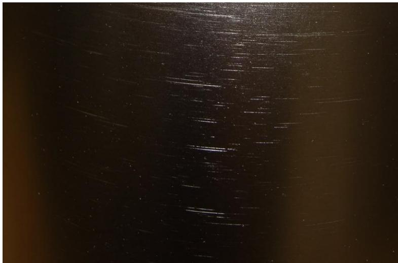
Abbildung 69: Photo des Titan-Targets nach einem Beschichtungsversuch.
