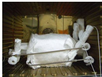
Abbildung 3.49: Testmodul mit Feed- sowie Sweepgasvorheizung in unterer Keramikheizschale (links) und Installation im Wärmeschrank mit Isolierung (rechts)
