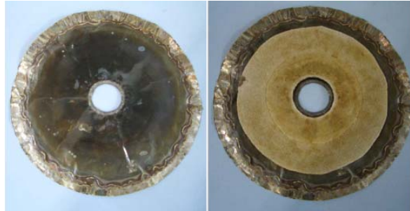
Abbildung 3.68: Rückstandanhaftungen an Membranen und Spacermaterial im Inneren eines Membrankissens
