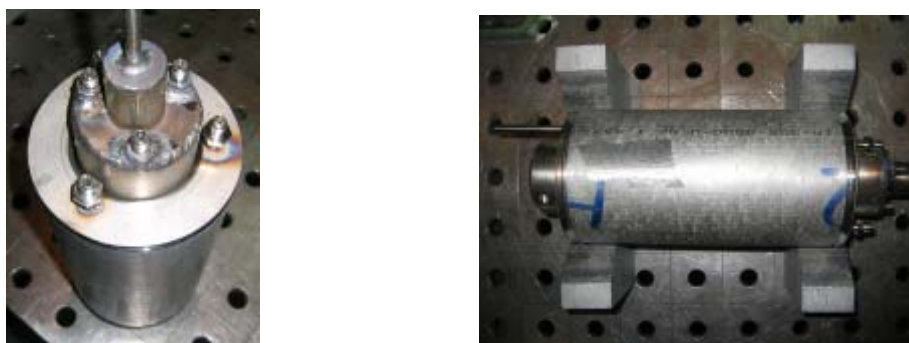
Abbildung 3.25: Fertigung des Membranreformers
