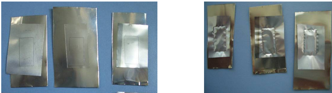
Abbildung 3.73: Pd-V-Membranen verschweißt auf einer 40 µm starken und weichgeglühten Edelstahlfolie; vor (links) und nach (rechts) H 2 -Atmosphäre (350°C, 3 bar abs )
