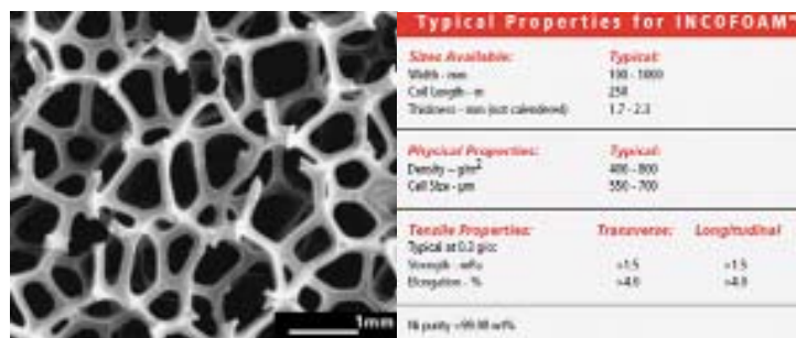
Abbildung 3.19: Datenblattausschnitt des Metallschaums „Incofoam“
