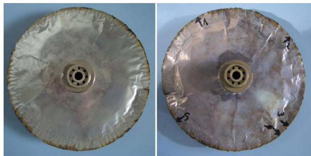
Abbildung 3.67: Membrankissen vor (links) und nach (rechts) H 2 -Beaufschlagung
