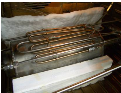
Abbildung 3.49: Testmodul mit Feed- sowie Sweepgasvorheizung in unterer Keramikheizschale (links) und Installation im Wärmeschrank mit Isolierung (rechts)
