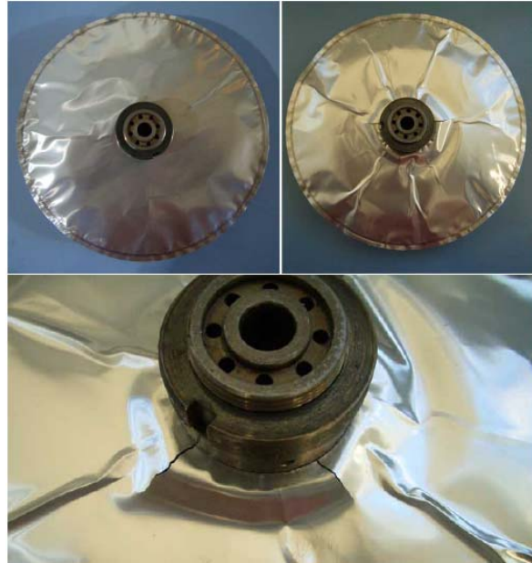
Abbildung 3.72: oben: Membranmodul vor (links) dem Wasserstofftest und danach (rechts) sowie unten: Detailansicht Membranversagen
