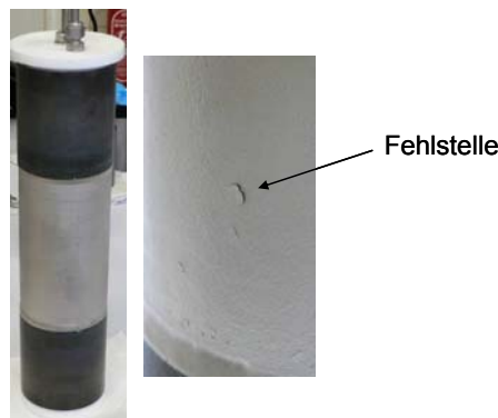
Abbildung 3.44: Oberflächendefekte auf einer mit Pd beschichteten Rohrmembran
