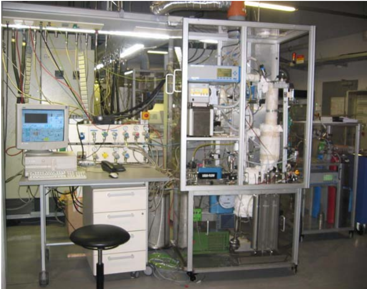
Abbildung 3.26: Teststand für den Biodiesel-Membranreformer im ZBT-Labor
