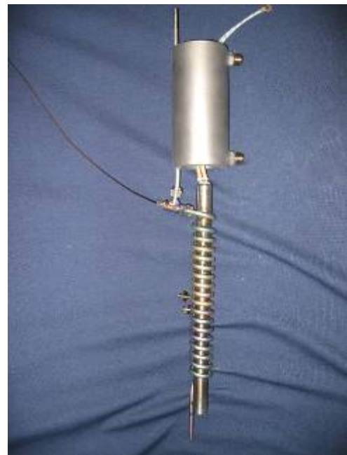
Abbildung 3.5: Schematischer Aufbau (links) und Wasser-Verdampfer und Gemischbildungseinheit (rechts)
