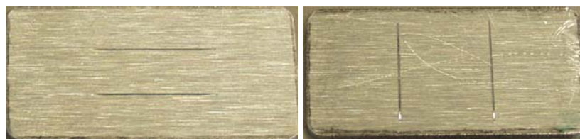
Abbildung 4.7: Aufnahmen der angefertigten „Kratzer“ bzw. „Spalte“
