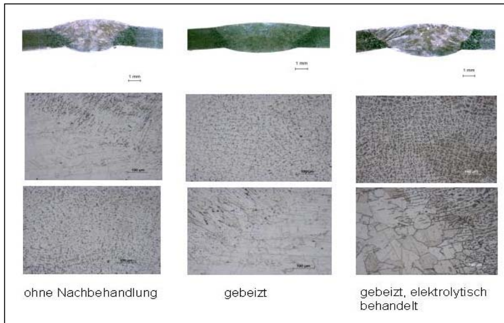
Abbildung 3.31: Querschliffe von WIG-Schweißnähten, unterschiedlich bearbeitet
