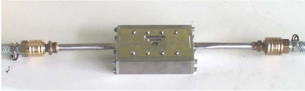
Abbildung 4.16: Messzelle des Mikrokanals mit Zuströmdüsen
