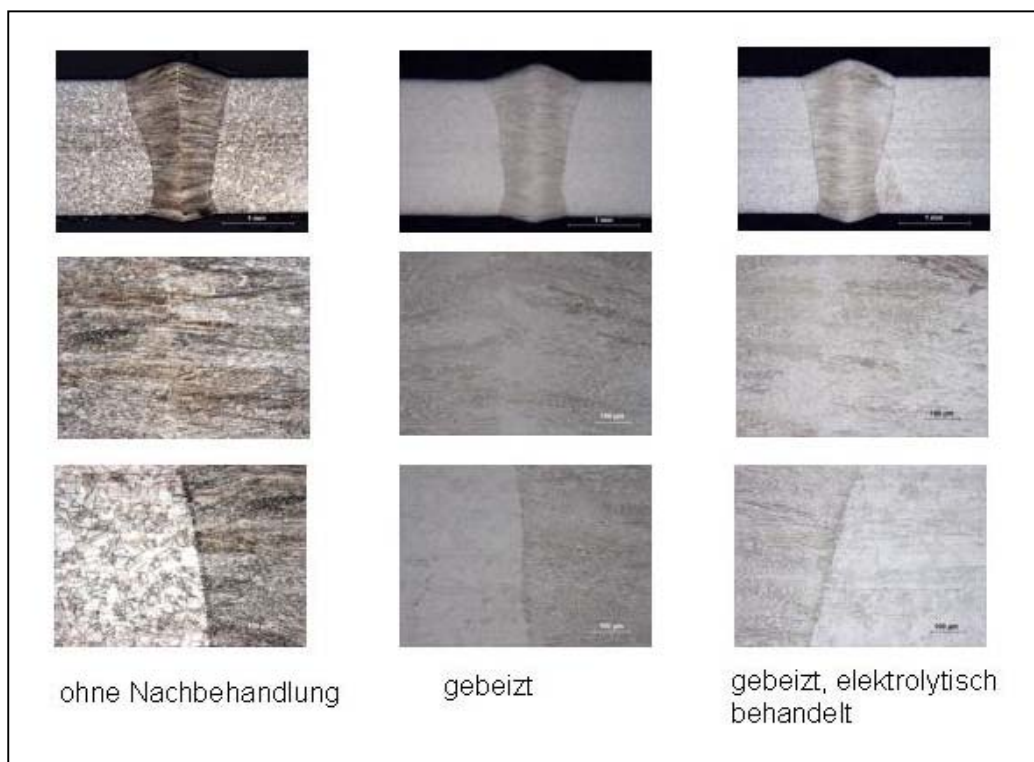
Abbildung 3.32: Querschliffe an Laserschweißnähte ohne Zusatzwerkstoff, unterschiedlich bearbeitet
