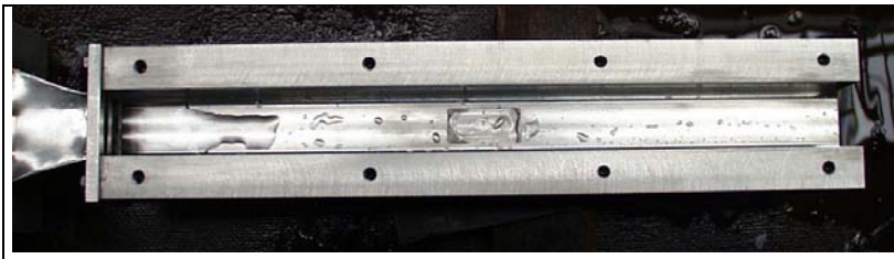
Abbildung 4.14: Aufsicht auf den Kanal mit eingefräster Nut zur Probenbefestigung
