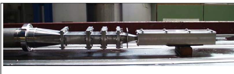
Abbildung 4.13: Seitenansicht des Strömungskanals und der Zustromdüse. Flächenkontraktion 6:1
