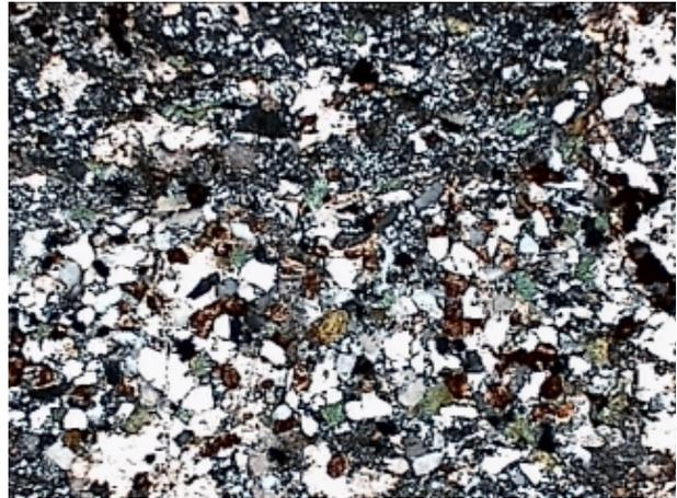
Abbildung A2 13: BB = 2,1 mm, X-pol; dichtver-kieselte Matrix
