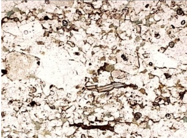
**Abbildung A2 6:** BB = 2,1 mm, lin-pol; eingeregelt Grundmasse mit einzelnen größeren Körnern, durchgehende Eisenhydroxid-Verwitterung
