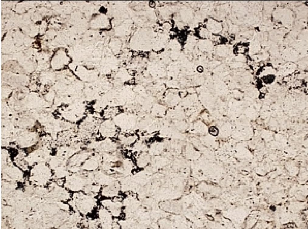
Abbildung A2 19: BB = 2,1 mm, lin-pol; 3-dimensional vernetzter Porenraum
