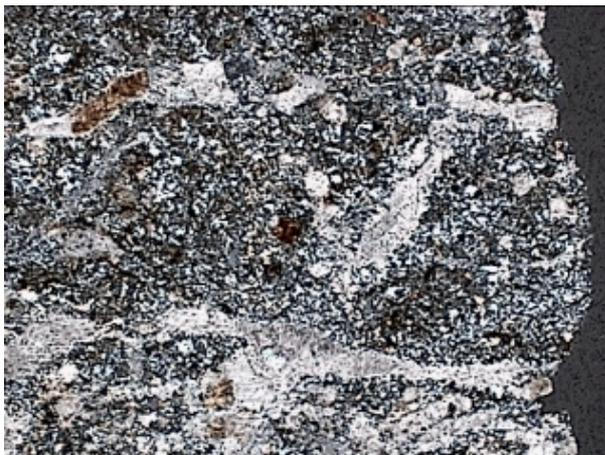
Abbildung A2 17: BB = 2,1 mm, X-pol; Flint mit Carbonatdurchhäderung
