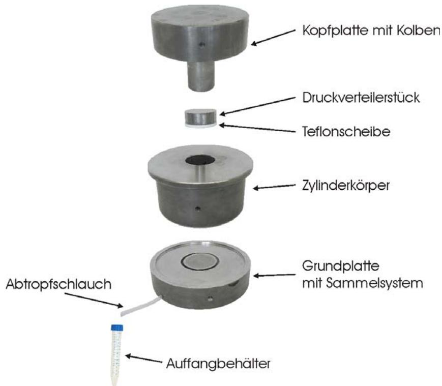
Abbildung 4-1: Schemadarstellung der Auspressvorrichtung für die Porenlösung von Beton
