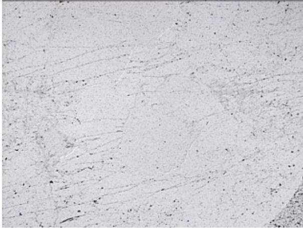
**Abbildung A2 20: BB = 2,1 mm, lin-pol; mit spröden Zerbrechungen durchsetzter Quarzit**
