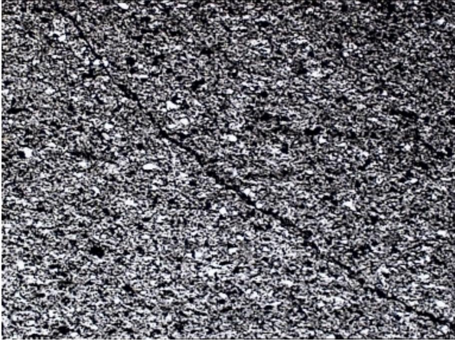
Abbildung A2 37: BB = 2,1 mm, lin-pol; leicht geschiefertes toniges Gefüge mit Zerrkluft diagonal zur Schieferung
