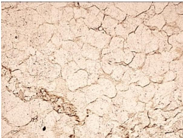
**Abbildung A2 22: BB = 2,1 mm, lin-pol; Quarzit mit durchgreifendem Netzwerk einer Glimmertapete**
