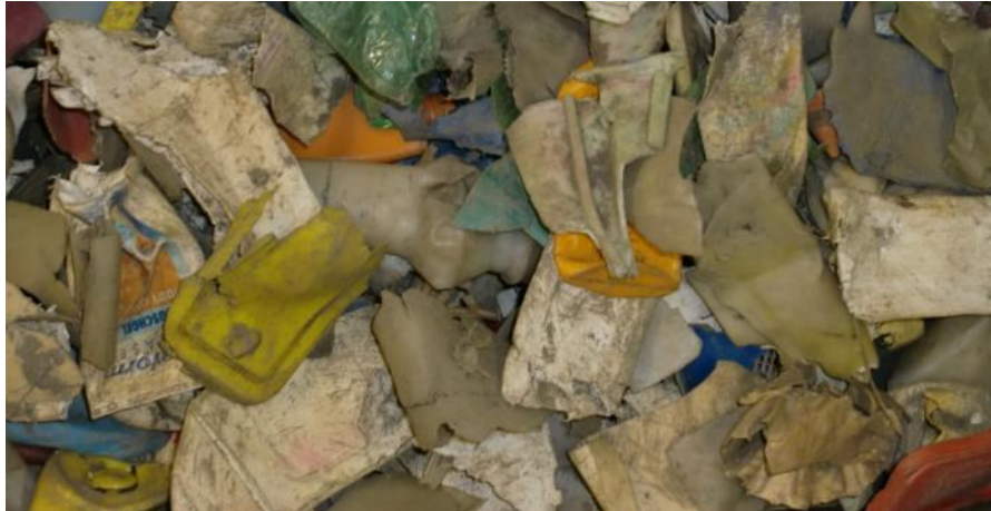
Abbildung 5-7: 3D-Kunststoffe aus rückgebautem Deponiematerial 24
