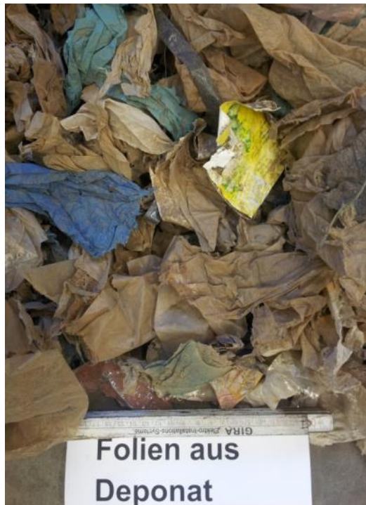
Abbildung 5-8: Abgetrennte Folien aus rückgebautem Deponiematerial
