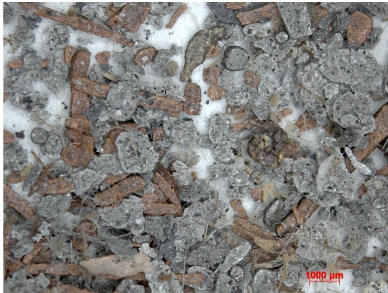
Abbildung 5-6: Kupfer-Aluminium-Mischkonzentrat der Feinkornaufbereitung
