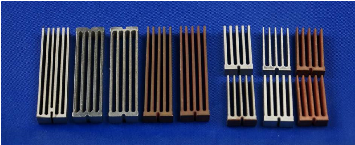
Abbildung 54: Verschiedene WINGS (teilweise vernickelt)
