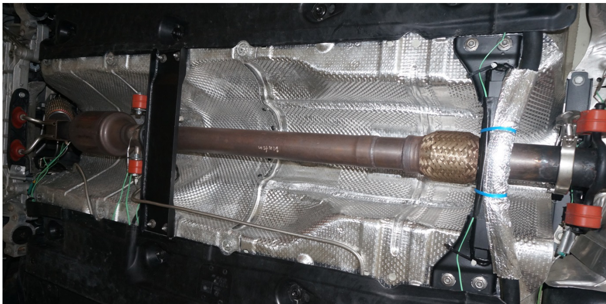
Abbildung 99: Umgebaute Abgasanlage ohne TEG-System
