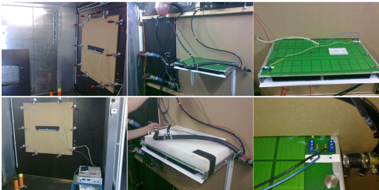
Abbildung 151: Einbau des TEG in Wärmetauscher-Prüfstand
