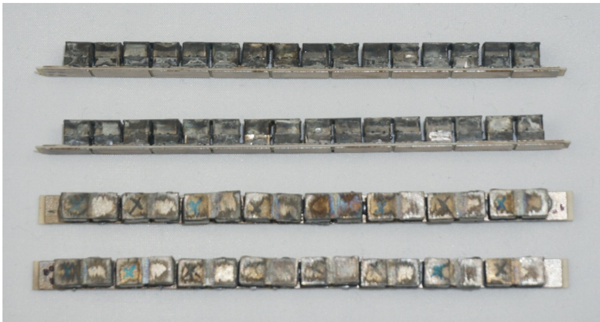
Abbildung 59: segmentierte Schenkelpaare auf Substratstreifen für Variante a)
