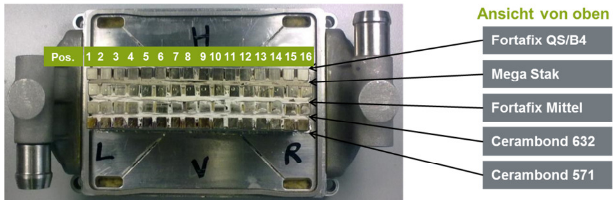
Abbildung 136: 4-Streifen Modul ohne TE-Material mit einzelnen verlöteten Cu-Wärmeübertragern (Wings)
