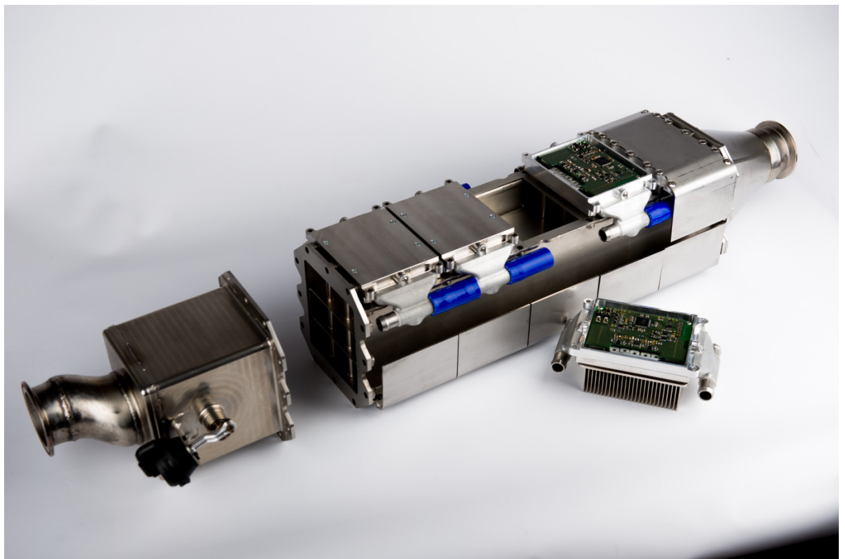
Abbildung 72: TEG-Prototyp mit internem Bypass, Abgasklappe und 10 „all-in-one“-Modulen
