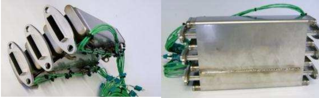
Abbildung 2-49 fertiger halbseitiger TEG
