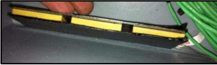
Abbildung 2-34 Verbund aus Zirkonoxiddummys, Graphitfolien und Thermoelementen
