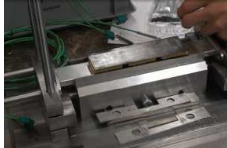
Abbildung 2-45 Der zweite Verbund aus Dummies, Graphitfolien und Thermoelementen wurde positioniert
