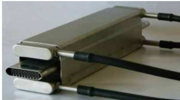
Abbildung 1-1 Prototyp der TEG – Einheit im Projekt „Modul TEG“ mit Dummy's
