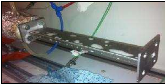
Abbildung 2-33 Aufbau Dichtigkeitsprüfung Abgaswärmeübertrager
