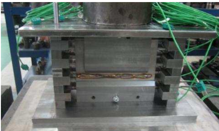
Abbildung 2-48 WIG-Schweißnaht der beiden Mantelschalen
