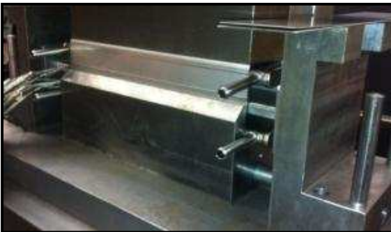
Abbildung 2-39 vorgespannter Aufbau im Presswerkzeug (mit Dummy's)
