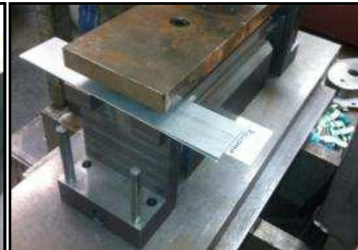
Abbildung 2-36 Submodul im Werkzeug fixiert
