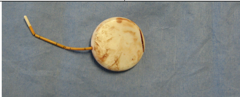
Abbildung 17: Katheter an zwei Stellen bei der Freipräparation angeschnitten, in Folge Undicht und Drähte durchtrennt
