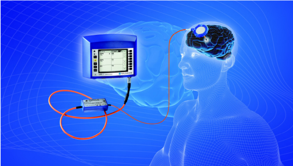
Implantierbarer Telemetrie Katheter zur Messung des Hirndrucks
