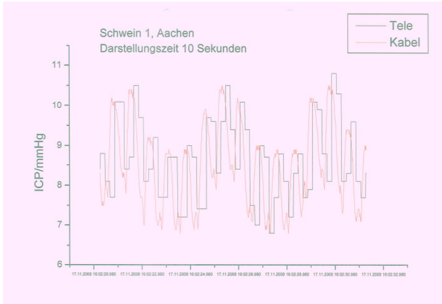
Abbildung 11: gute Übereinstimmung auch in der Feinstruktur des ICP zwischen Telemetriekatheter (schwarze Kurve) und Referenzkatheter (rote Kurve).
