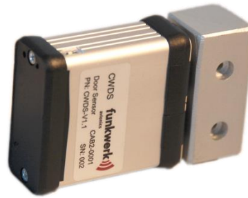
Bild 12: Sensormodul Türüberwachung mit Gegenstück
