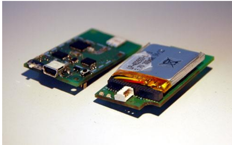
Bild 8: Sensormodul Temperaturmessung - Platinen und Batterie
