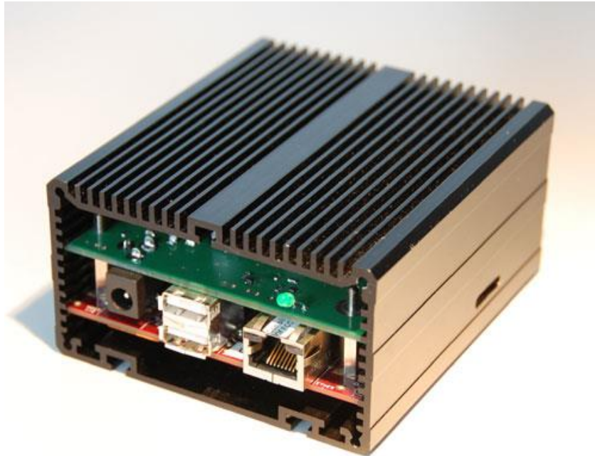
Bild 15: Wireless Data Concentrator (WDC)
