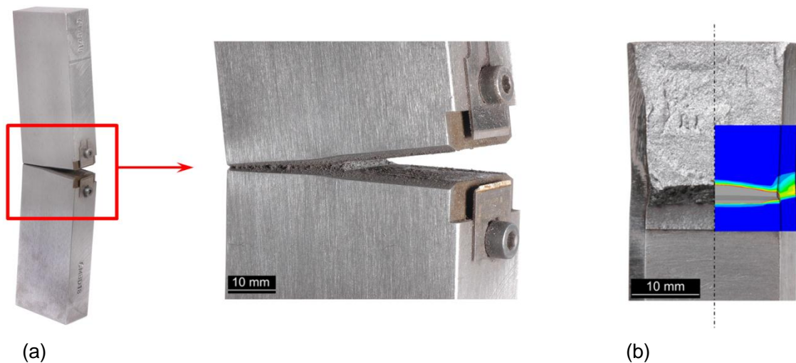
Abbildung 58: Darstellung einer SE(B)25x50-Probe mit der Prüftemperatur von 20 °C: (a) nach dem Versuch [Roos & Seebich, 2006] und (b) Vergleich der Rissfront zwischen Experiment und Simulation
