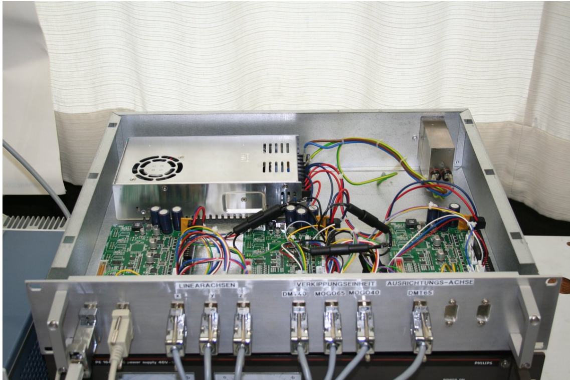
Abbildung 2.40: Das Steuermodul des Radmessplatzes RMP3 kontrolliert sieben Schrittmotoren und einen Antriebsmotor, der wahlweise als Schritt- oder BLDC-Motor montiert werden kann [35, 9].
