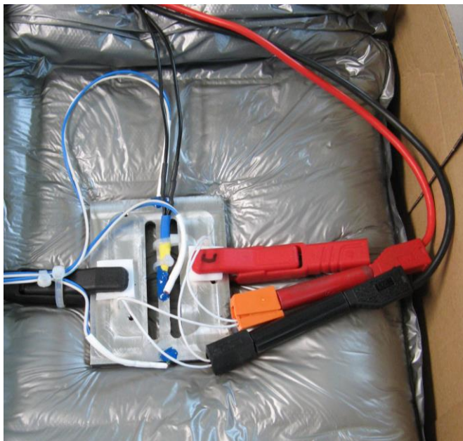
Bild 14: Aufheizversuche mit den beiden PTC Heizelementen
