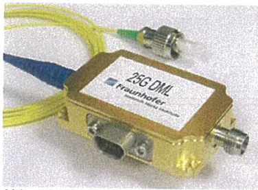
Abb. 21 Hochfrequenzmodul für einen 25Gbit/s-DML mit HF-V-Konnektor und FC/APC-Faseranschluss.
