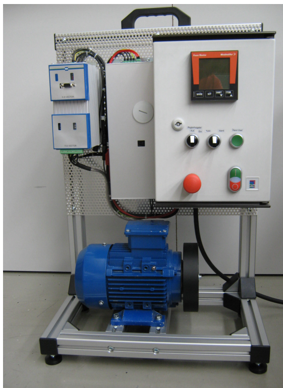
Abbildung 53: Demonstrator mit Frequenzumrichter von Firma MSF
