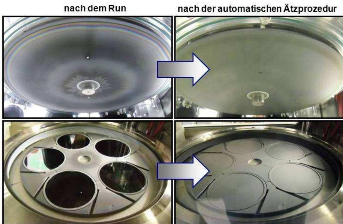
**Abbildung 36: Fotos eines beschichteten Planetenreaktors nach einem typischen Abscheidungsprozess für eine AlGaIn-basierte Bauelementstruktur (links) und nach der rezeptgesteuerten in-situ Reinigung (rechts). Die rechten Reaktorkonditionen entsprechen denen des Ausgangszustandes vor dem Abscheidungsprozess.**
