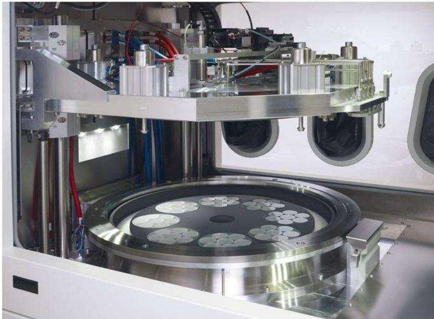
**Abbildung 1: MOCVD Planetenreaktor in ursprünglicher 56x2-Zoll Ausgangskonfiguration.**
