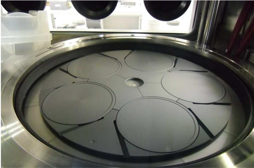
**Abbildung 3: MOCVD Produktionsanlage AIX G5 HT in neuer 5x200 mm Prototypenkonfiguration.**
