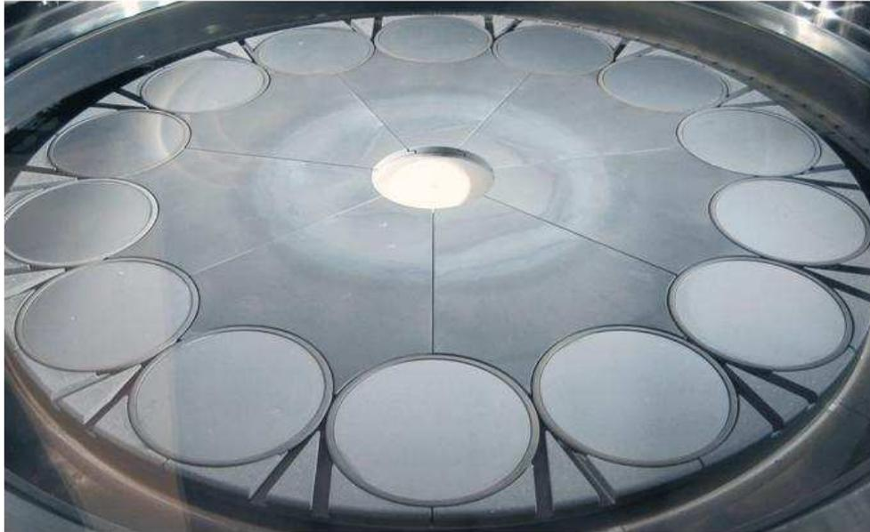
**Abbildung 18: Neuer 14x100 mm Sandwich Suszeptor mit einzelnen SiC-beschichteten Abdecksegmenten und Vorbereitung für den Einsatz eines Beladeroboters.**
