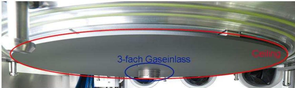
**Abbildung 2: Dreifacheinlass und Ceiling des neuen horizontalen MOCVD Reaktors für die industrielle Herstellung von GaN-basierten Hochspannungsbauerelementen für die Leistungselektronik auf 100 mm und 150 mm Substraten.**
