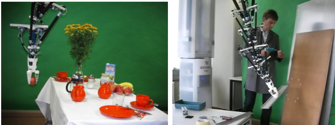
Abbildung 11: Tripedale Alternanzkaskade (TAK) in der Anwendung, links als Helfer am Tisch und, rechts in der automatischen Montage, nachgestellt an der TUB (Foto: TU Berlin)
