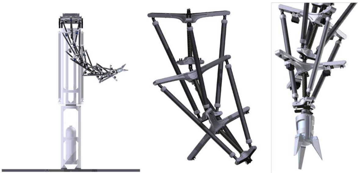
Abbildung 3: Tripedale Alternanzkaskade; gesamte Rüsselkinematik (links), zwei ineinander kaskadierte Segmente (mitte), Endsegment mit Greifer (rechts)
