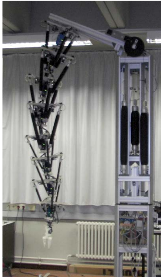
Abbildung 10: Tripedale Alternanzkaskade (TAK) mit einem Kopfsegment aus 2 Gelenken, 7 gleichartigen Segmente à 2 Gelenken und einem Greifersegment mit FinRay-Greifer (Foto: TU Berlin)
