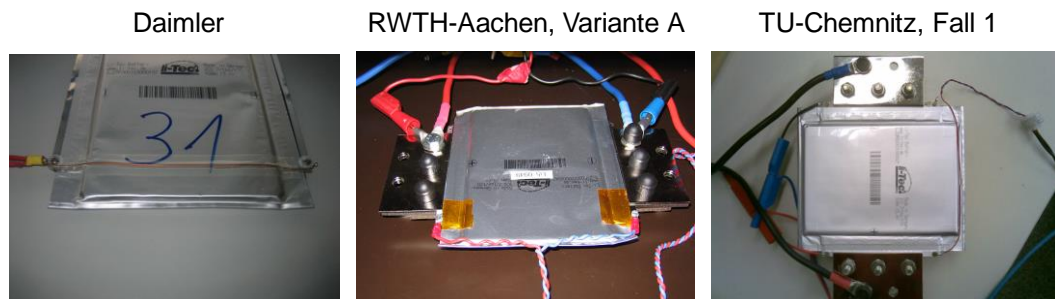
Abbildung 62: Führung der Sense-Leitung bei verschiedenen Projektpartnern
