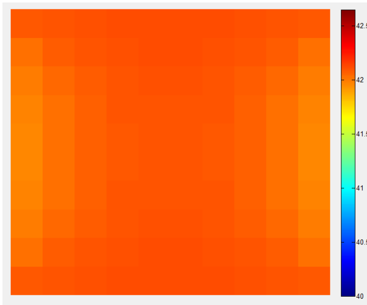
Abbildung 167: Aufsicht auf die Temperaturverteilung in der Generation 1 Zelle Die Ableiter befinden sich links und rechts. Der Temperaturgradient bewegt sich im Bereich unter 1°C
