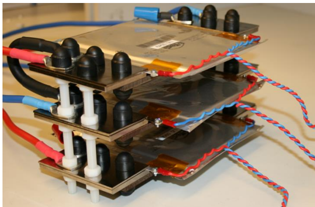
Abbildung 59: Aufbau zur EIS Messung bei Generation 1 Lagerungstests.
