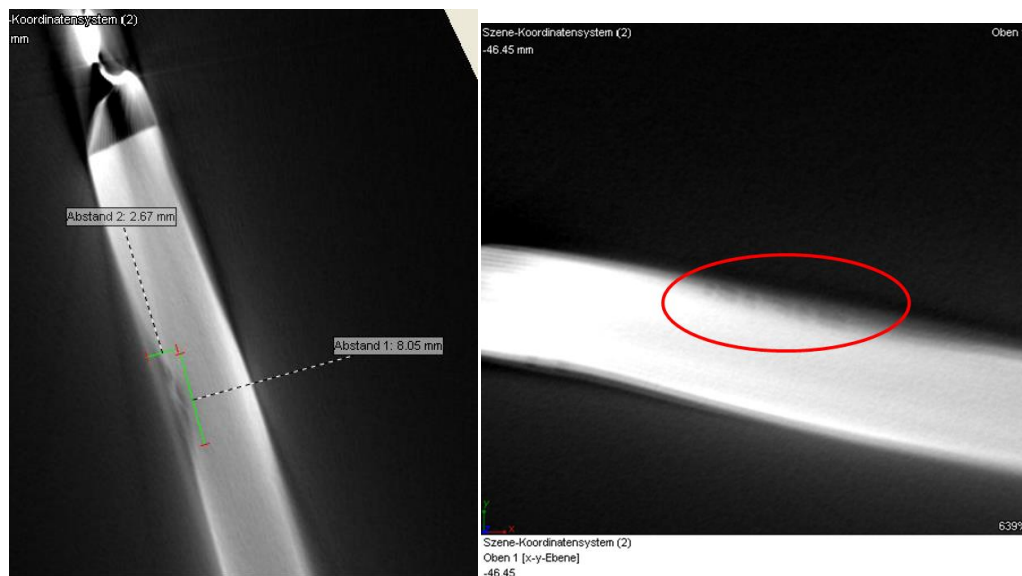
Abbildung 79: Detektion von eingeschlossenen Luftblasen mittels CT-Analyse
