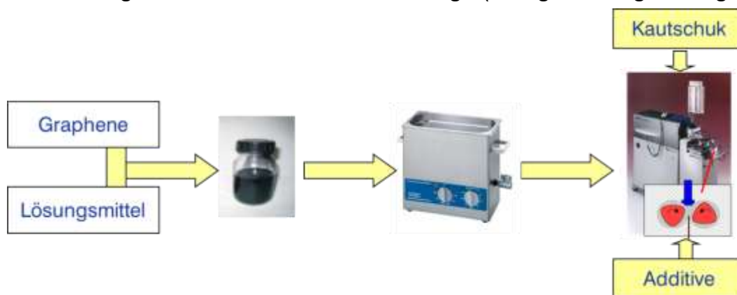
Abbildung 15: Schematische Darstellung zur Herstellung von Elastomerkompositen mit Ultraschall behandelten Graphenen
