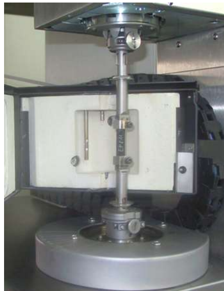
Abbildung 2 Rheometer (ARES, Rheometric Scientific) mit Probenhalter für Streifenproben und geöffneter Temperierkammer mit eingespannter Probe.
