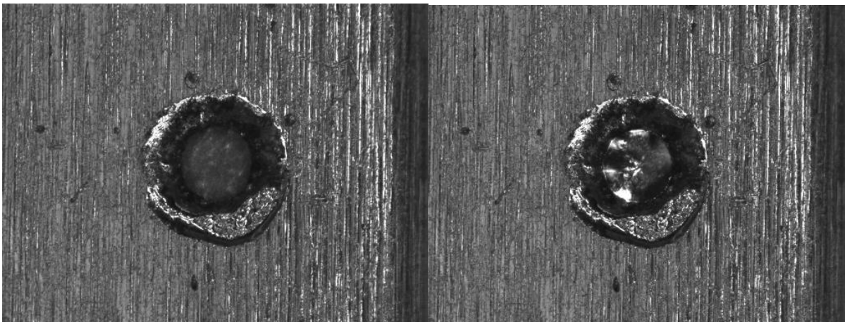
Abbildung 62. Detailansicht einer Lötstelle vor (links) und nach (rechts) dem Lötprozess, sichtbar wird die Platzierung des Lotes und die Benetzung am Umfang des zylinderförmigen Vias (Viadurchmesser 280 \mu\text{m} ). Die deutlichen Schmelzränder um das Via gehen auf den laser-basierten Bohrprozess zurück.
