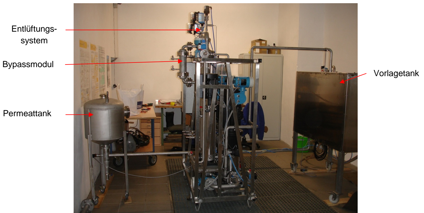
Abbildung 4-9: Anlage mit angeschlossenen Vorlage- und Permeattank
