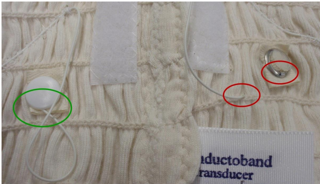
Abbildung 77: Intakter (grün) sowie gerissener (rot) Kontakt eines Atmungsbands
