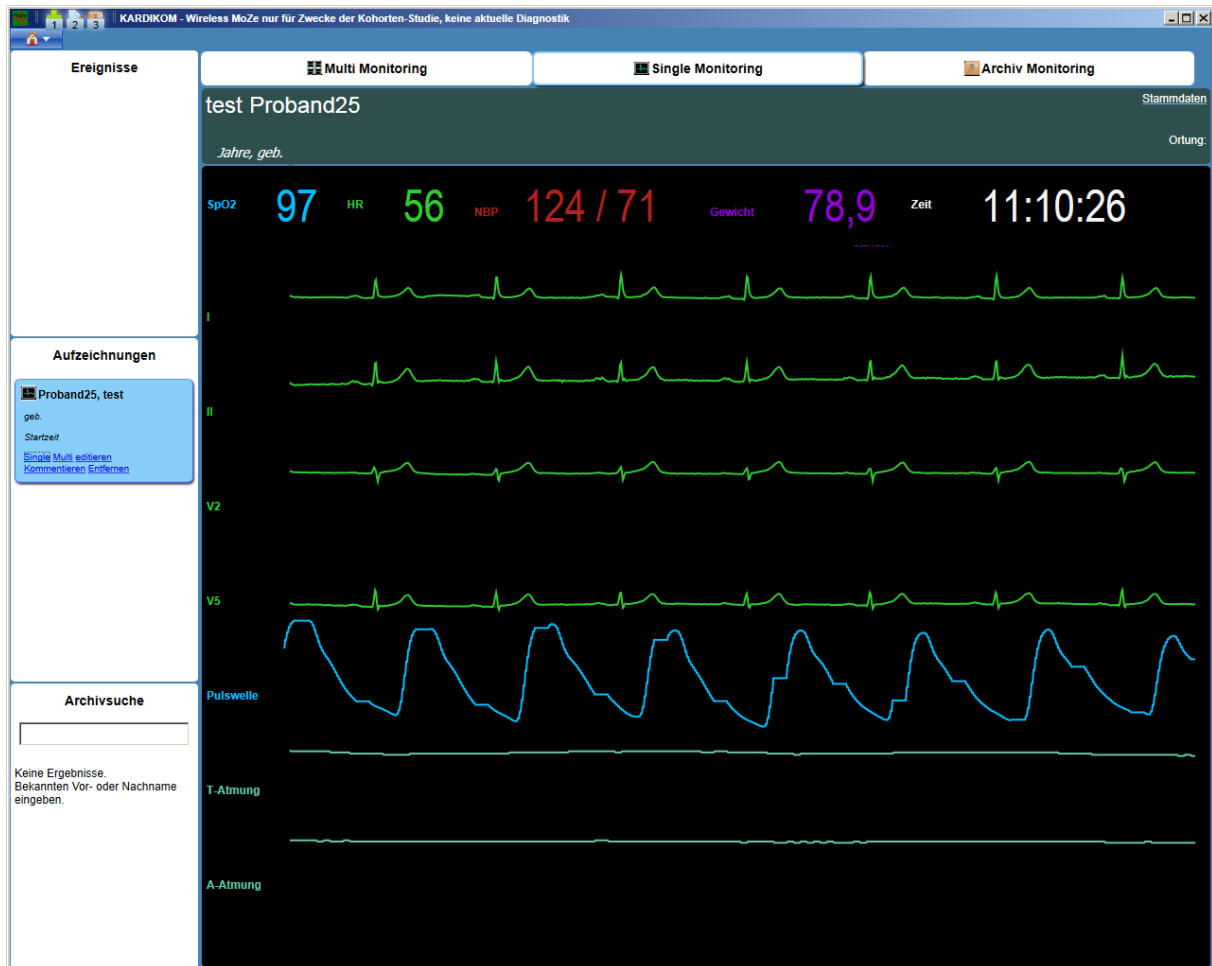
Abbildung 29: KARDIKOM-Wireless Datenloggersystem, Biosignale eines 71 jährigen von zuhause Die Abbildung zeigt die bei einem 71-jährigen zuhause aufgezeichneten Biosignale (EKG, Sauerstoffsättigung) auf dem Monitorbildschirm der KARDIKOM-Monitorzentrale im Einzeldarstellungsmodus (Single Monitoring). Auf dem Monitorbildschirm werden die Herzfrequenz, die Sauerstoff-Sättigung, der Blutdruck und das Gewicht als Zahlenwerte unter der Probandeninformation dargestellt. Darüber hinaus werden die Kurvenverläufe des Elektrokardiogramms (I, II, V2, V5), des Photoplethysmogramm (Pulswelle) und die Brust- bzw. Bauchatmung graphisch dargestellt.
