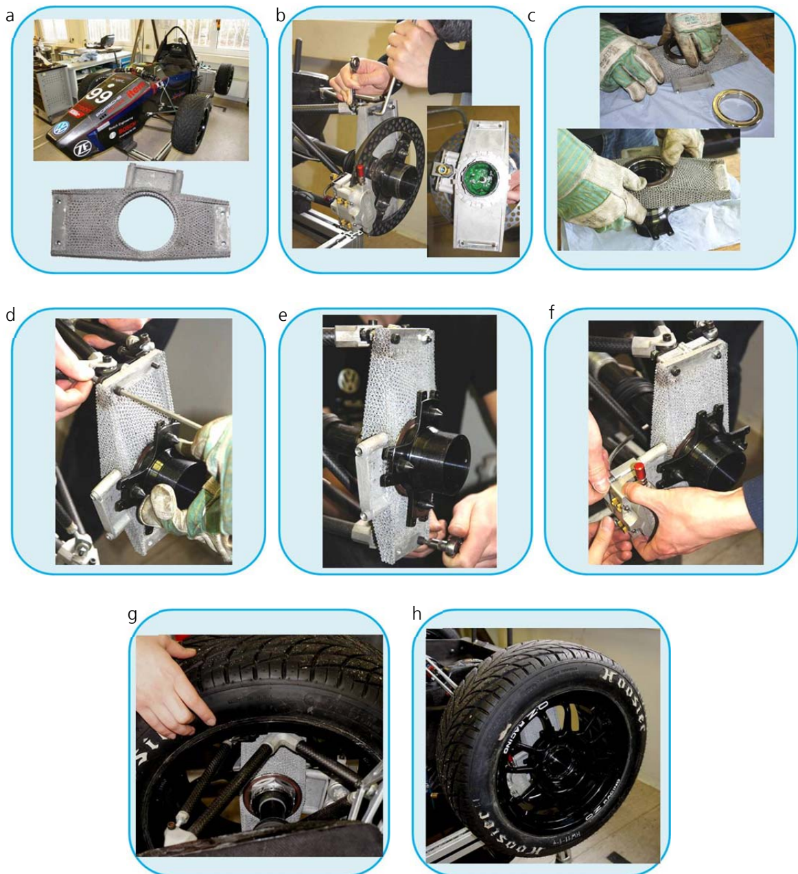
Abb. 48: Einbau des zellular gradierten Radträgers
