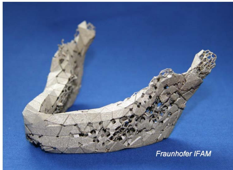
Abb. 2: Mittels Lasersinter-Verfahren hergestellter Unterkiefer aus gradiertem, zellularem Stahl
