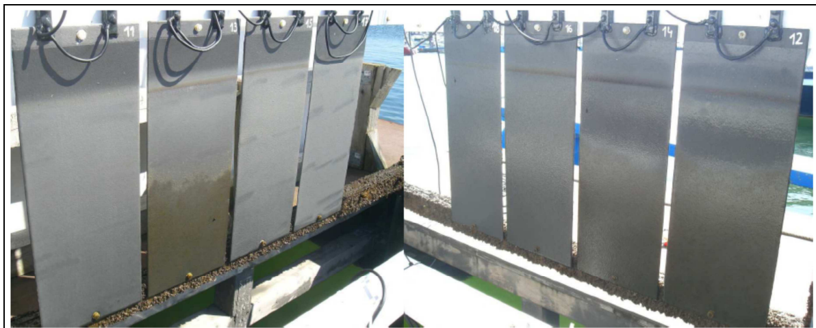
Abb. 60 Biofoulingexperiment an den TSW-Paaren 11/12, 13/14, 15/16 und 17/18, Zusammensetzung und Schichtstruktur siehe Tab. 11
