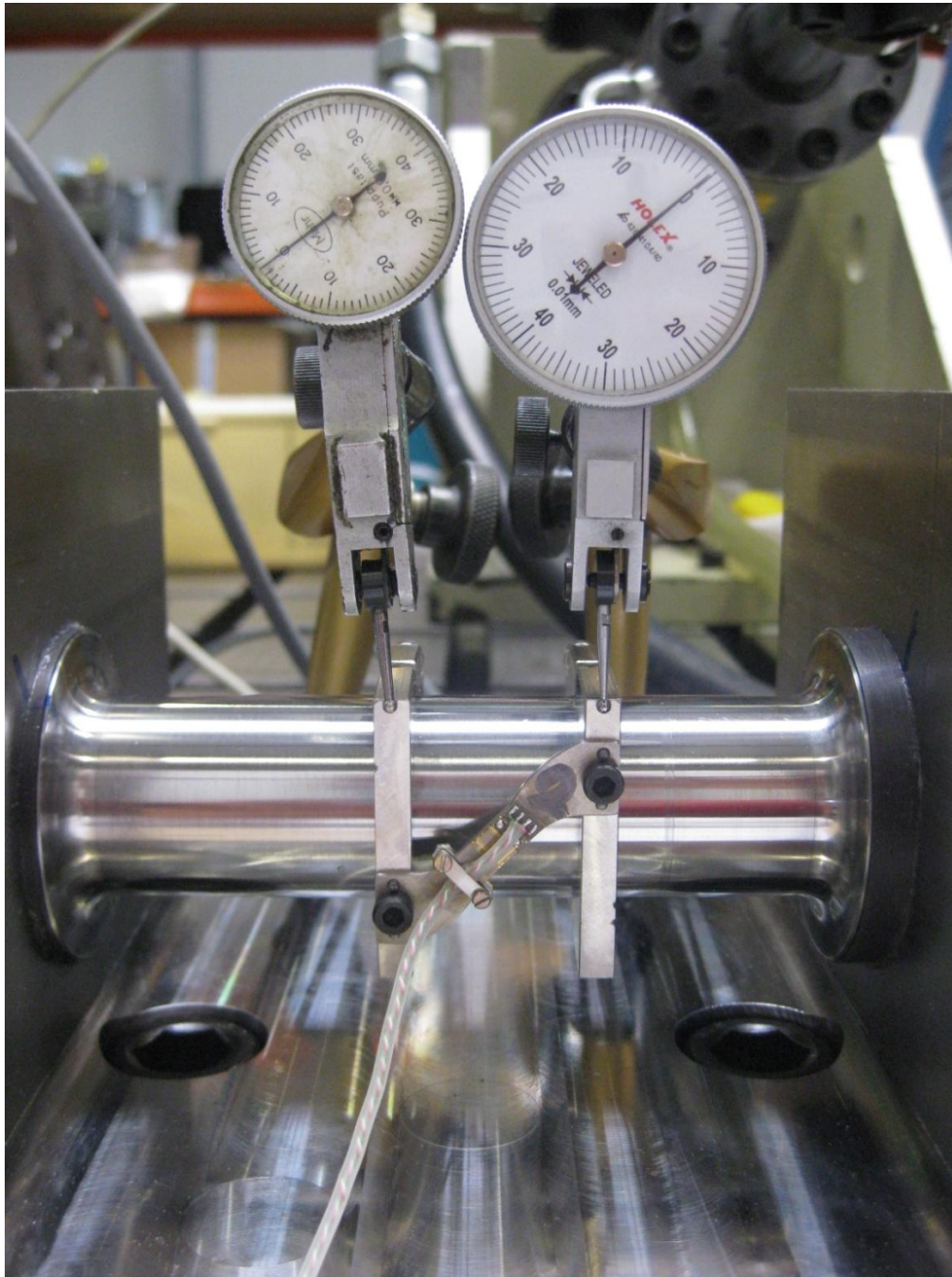
Abb. 44 Versuchsaufbau mit DMS 2 und zeitgleicher Messung der Klammerschenkel-Verschiebung senkrecht zur Torsionsachse mit analogen Messuhren.
