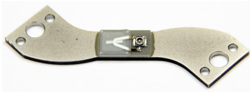
Abb. 30 OFW-Sensor fixiert mit dem Klebstoff AD295 auf S-Träger
