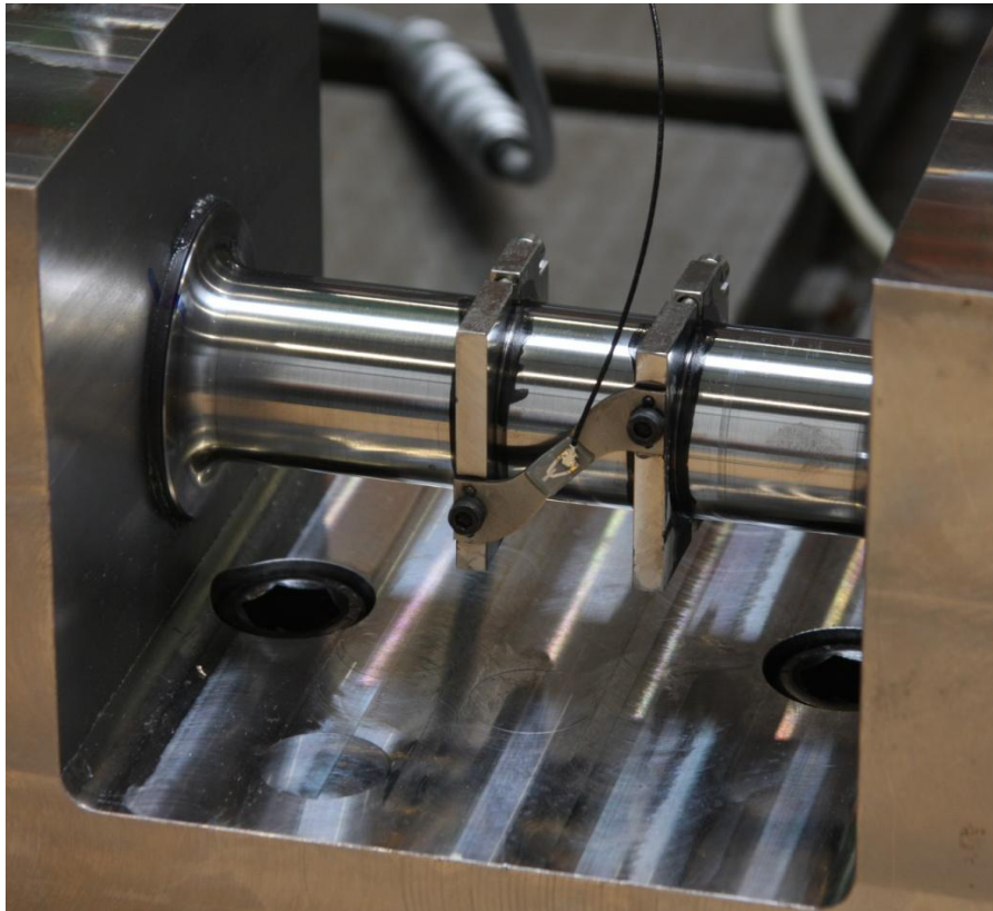
Abb. 47 Integrierter OFW-Sensor im Torsionsmessstand mit zusätzlicher Fixierung des S-Trägers und der Klemmbügel auf der Trosionswelle
