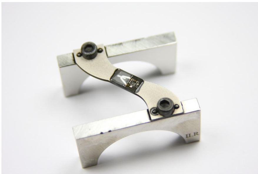
Abb. 38 Sensorträger geklebt auf Klemmbügel
