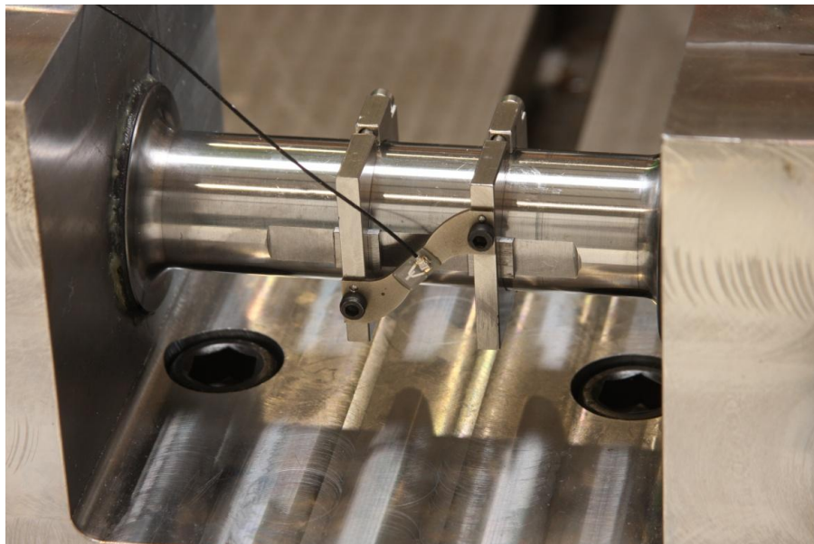
Abb. 53 OFW-Sensor auf S-Träger im Drehmomentmessstand mit abgeflachter Torsionswelle
