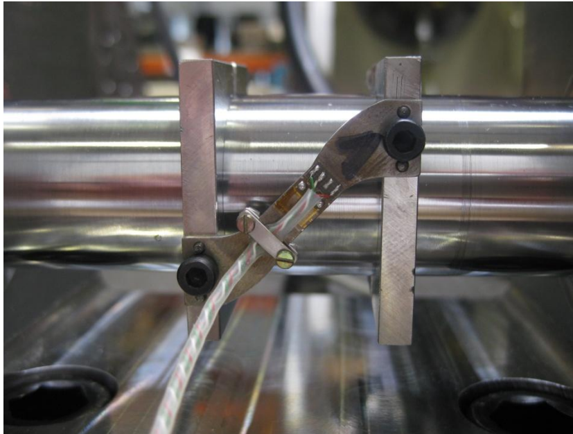
Abb. 41 DMS 1 aufgebaut auf S-Träger, montiert mit der Klammer II auf der Torsionswelle zur weiteren Untersuchung der Toleranz- und Gleiteffekte
