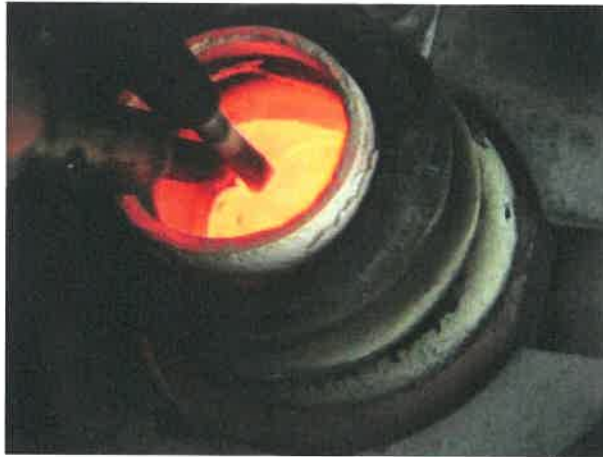
Abbildung 28: Momentaufnahme des Schmelz- Rührprozesses (Al+MWCNT)
