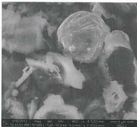
Abbildung 33: REM Aufnahme des unteren Tiegelrückstandes, \text{Al}_2\text{O}_3 ohne CNTs (Quelle iFW Dresden)
