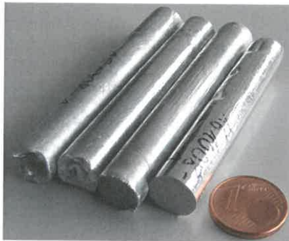
Abbildung 9: Mit der Versuchsanordnung hergestellte Gussstäbe
