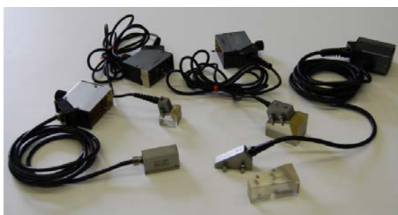
Konventionelle PA-Prüfköpfe Hersteller: Olympus, Sonaxis
