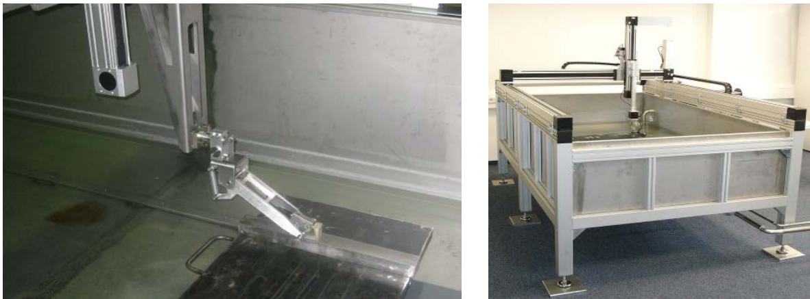
Abb. 54: SPA-Prüfsystem für Tauch- und Kontakttechnik mit 3-Achsenmanipulator
