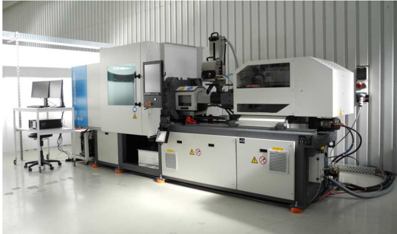
Abbildung 42: Demonstratormaschine mit segmentierter Werkzeugtemperierung und zustandsabhängiger kooperativen Regelung im Technikum der Fa. Krauss Maffei Technologies GmbH
