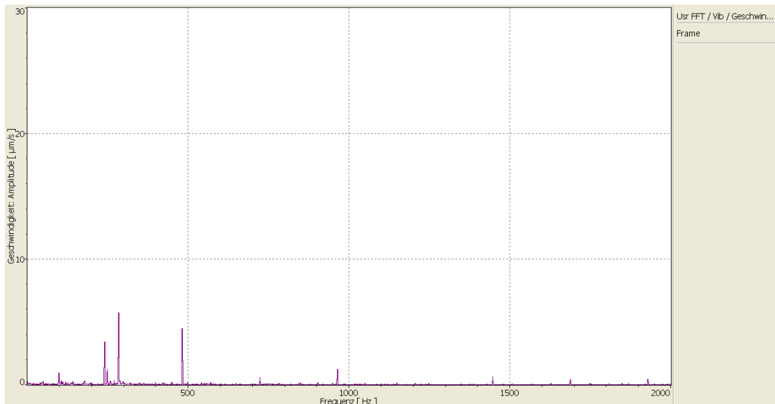
Abb. 4: HAMAMATSU x10468: Störlinien im Geschwindigkeitsspektrum gemessen Bereich von 0-2kHz
