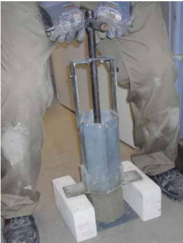
Entschalen des "grünen" Betonprüfkörpers
