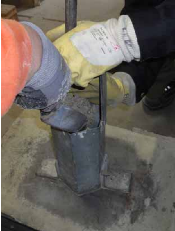
Befüllen der 6kant-Form
