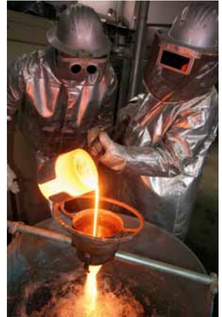
Bild 20: Hüttensandgranulation im Schmelzlabor
