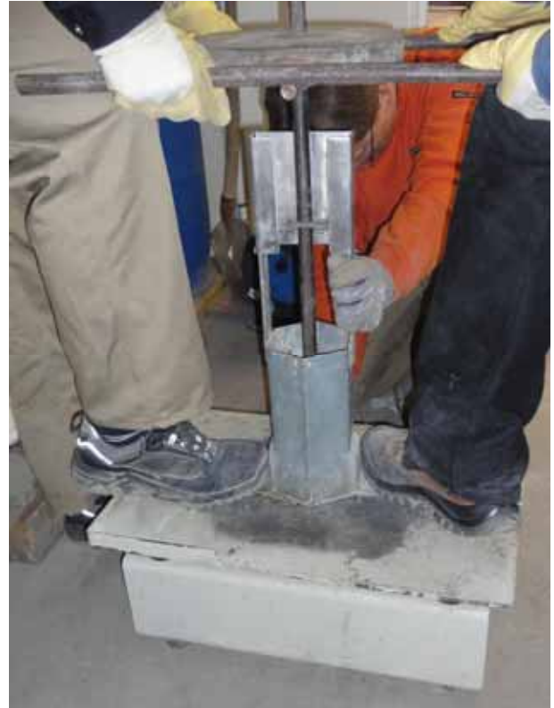
Verdichtung unter Auflast und Vibration
