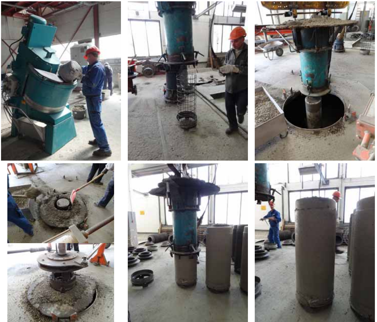
Bild 80: Herstellung der Betonrohre mit alkaliaktiviertem Hüttensand
