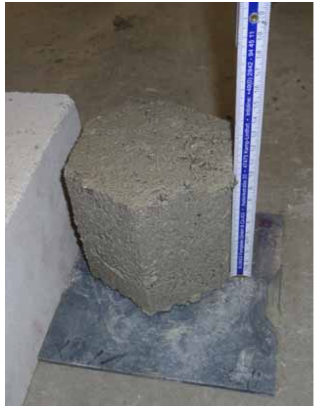
Betonprüfkörper nach dem Entschalen
