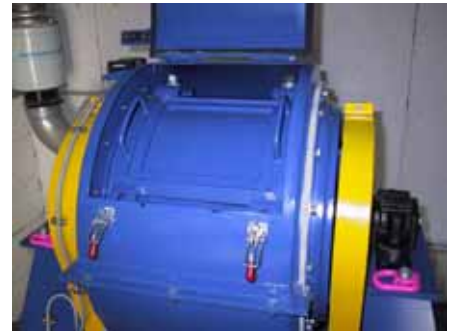
Bild 7: 10 kg-Kugelmühle des FEhS-Instituts
