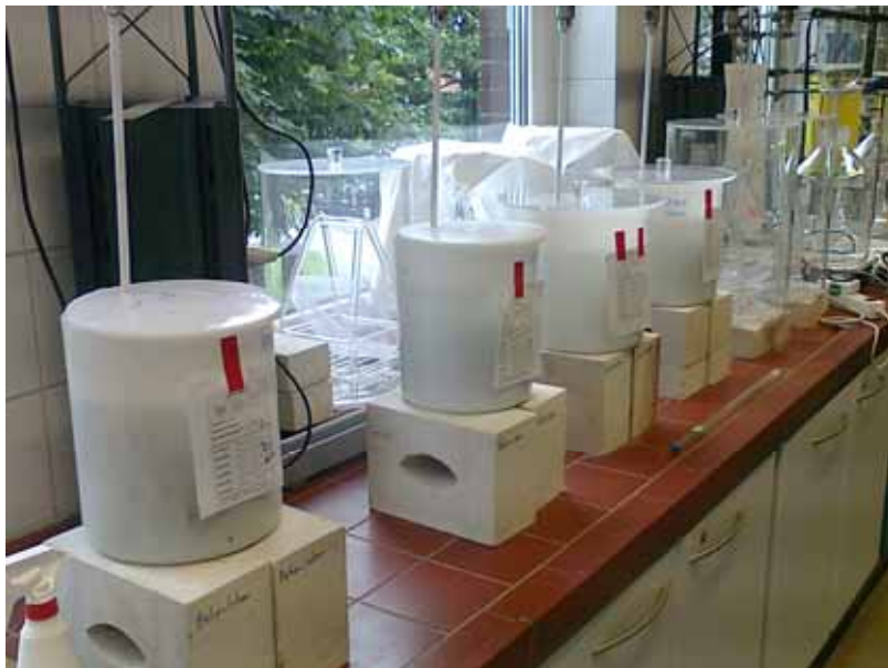
Bild 91: Elution der 6kant-Steine von 4 Betonen
