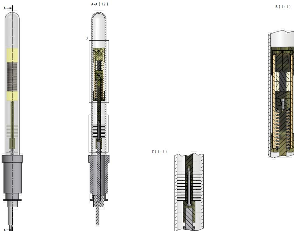
**Abbildung 7: Konstruktionsskizzen zur thermisch asymmetrisch gestalteten Probenkapsel der Gradientenapparatur – Außenansicht, Schnittdarstellung, Detail Wärmesenke, Detail Verspannung des Stabes im Keramikrohr**
