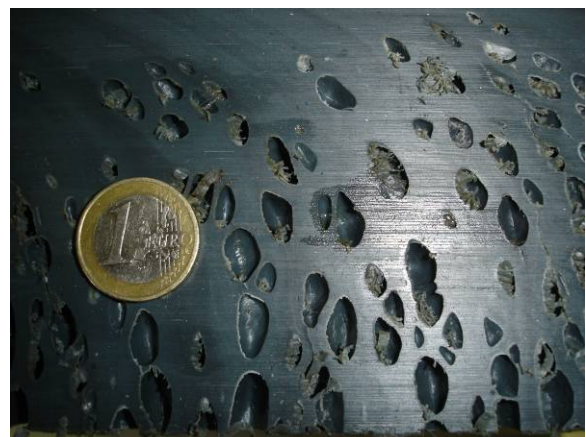
Abbildung 42: Profil 2 - Detail (Lunker)
