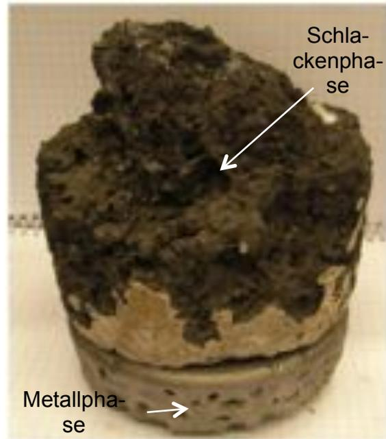
Abbildung 91: isolierter Schmelzblock des Versuches LBOII-2
