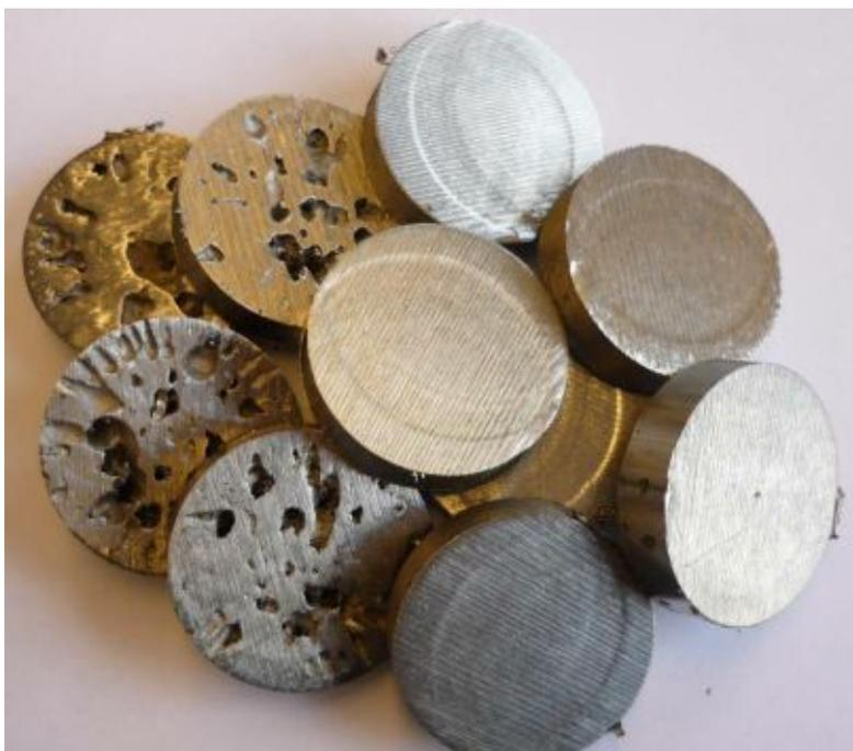
Abbildung 66: Aus den Legierungsstäben gesägte Metallscheiben
