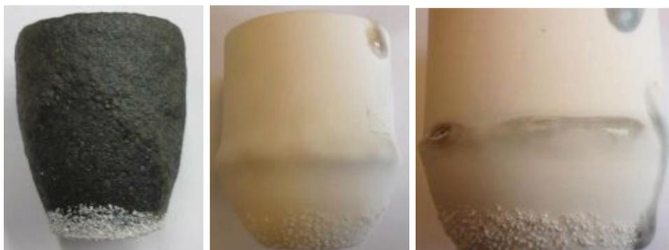
Abbildung 59: Tongrafit- und  $\text{Al}_2\text{O}_3$ -Tiegel nach dem Aufschmelzen der Schlacken
