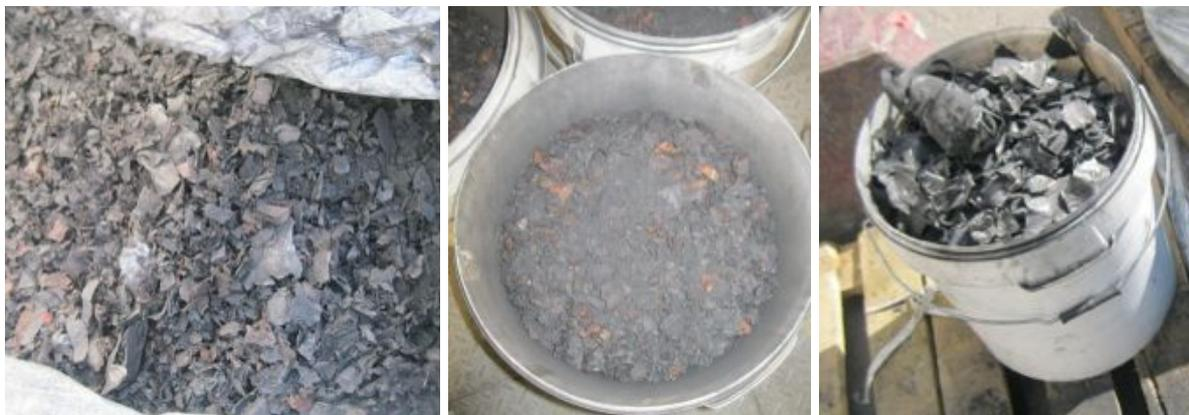
Abbildung 95: Batterierecyclingmaterial (links), nach Sortierung: Einsatzmaterial (Mitte) und aussortierte Eisenbestandteile (rechts)
