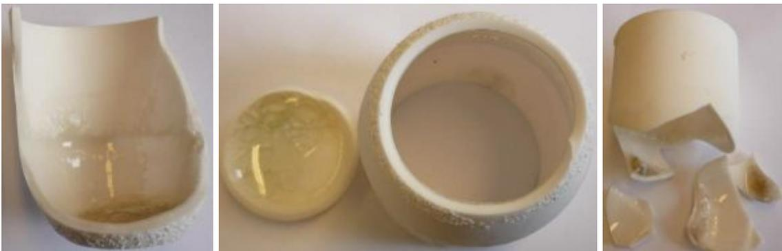
Abbildung 69: Durch beim Abkühlen entstehende Eigenspannungen zerstörte  $\text{Al}_2\text{O}_3$ -Tiegel
