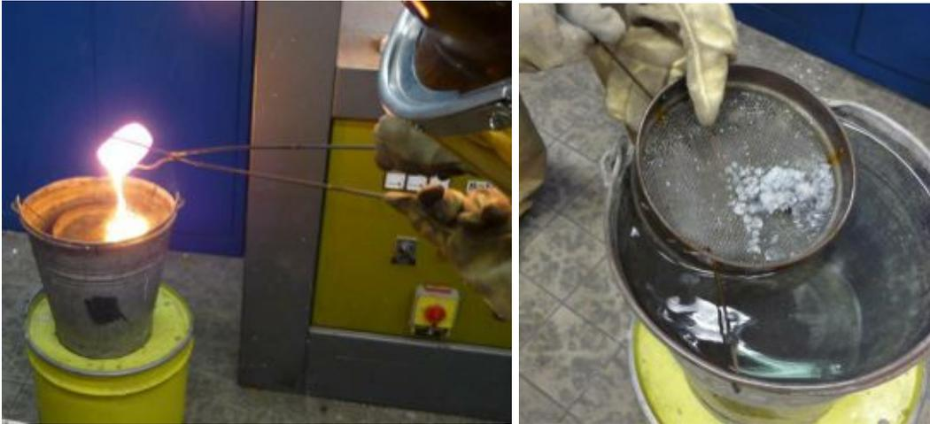
Abbildung 68: Abguss der Schlacke nach Versuchsende (links) und Abschreckkonstruktion mit aufgefangener Schlacke (rechts)
