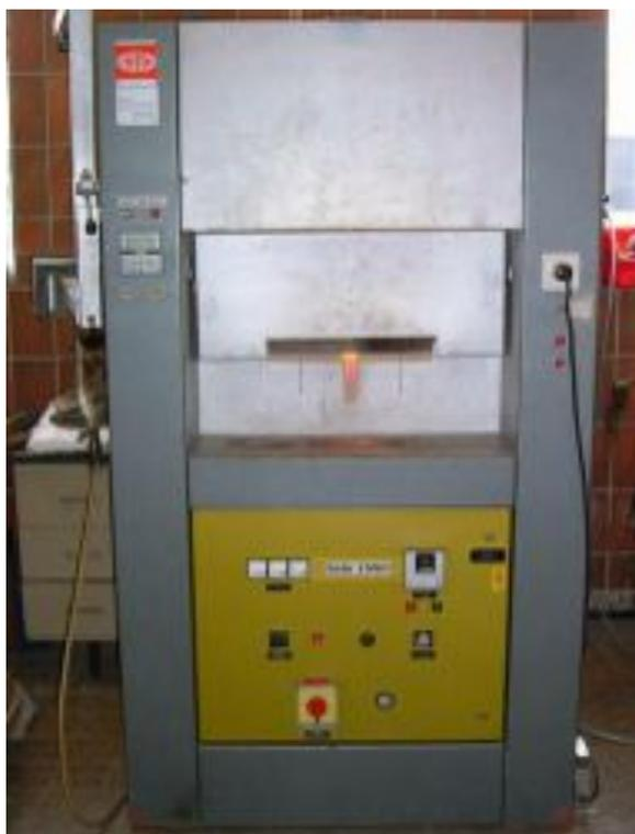
Abbildung 54: Wärmebehandlungsofen der Firma SOLO-Industrieofenbau
