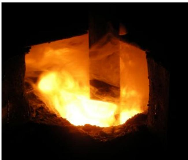
Abbildung 90: Rauchentwicklung während der Lichtbogenfahrweise
