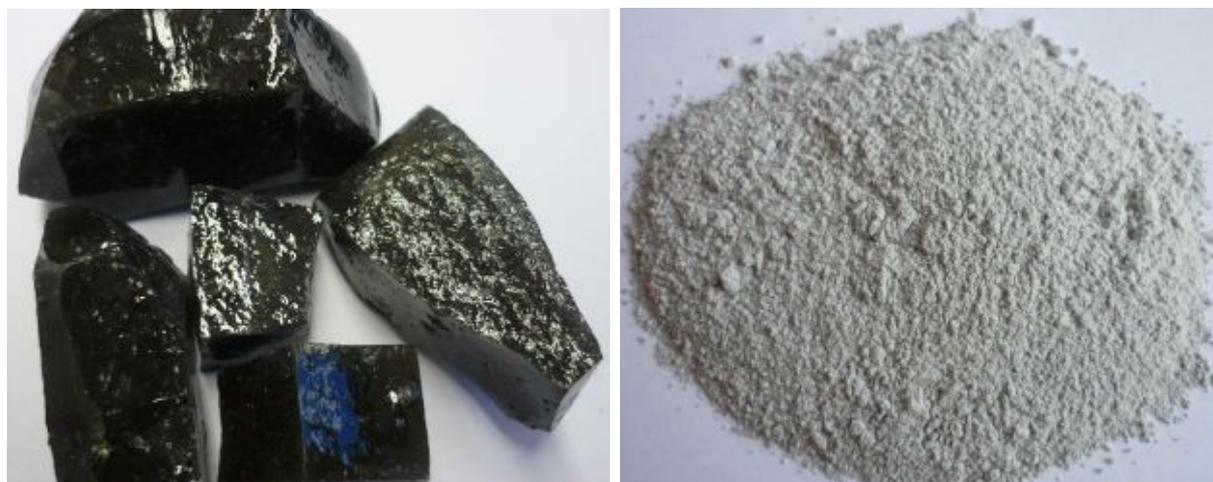
Abbildung 63: Erzeugte stückige und aufgemahlene Schlacke
