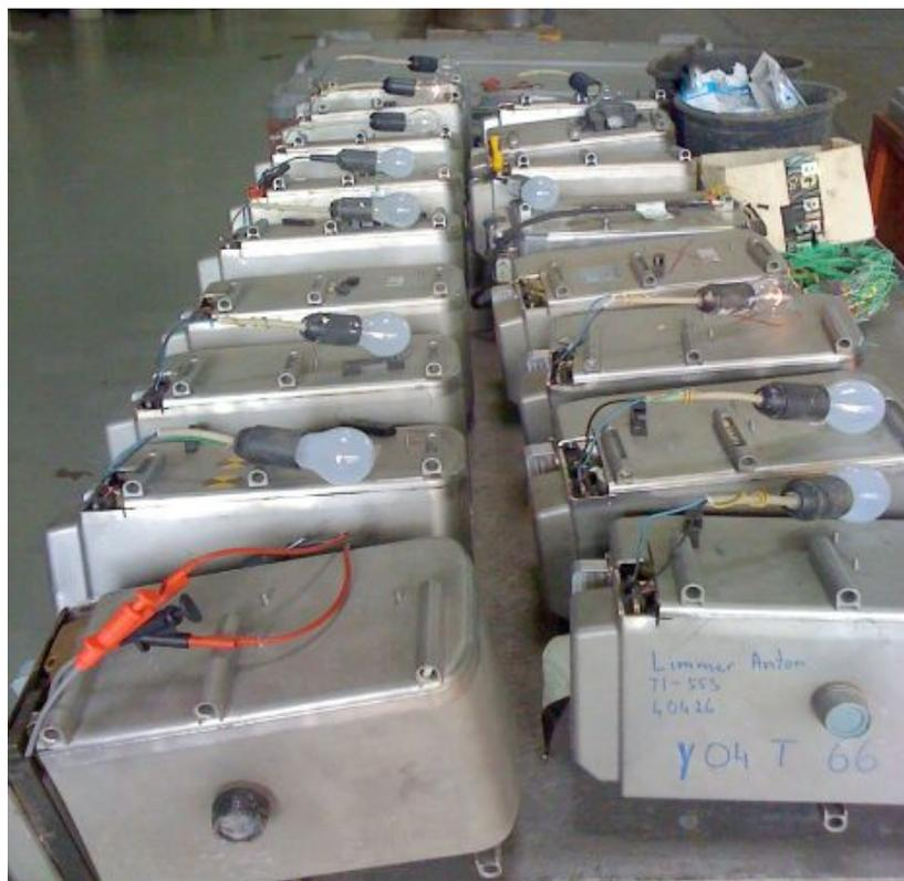
Abbildung 7: Batteriemodule nach Entladung
