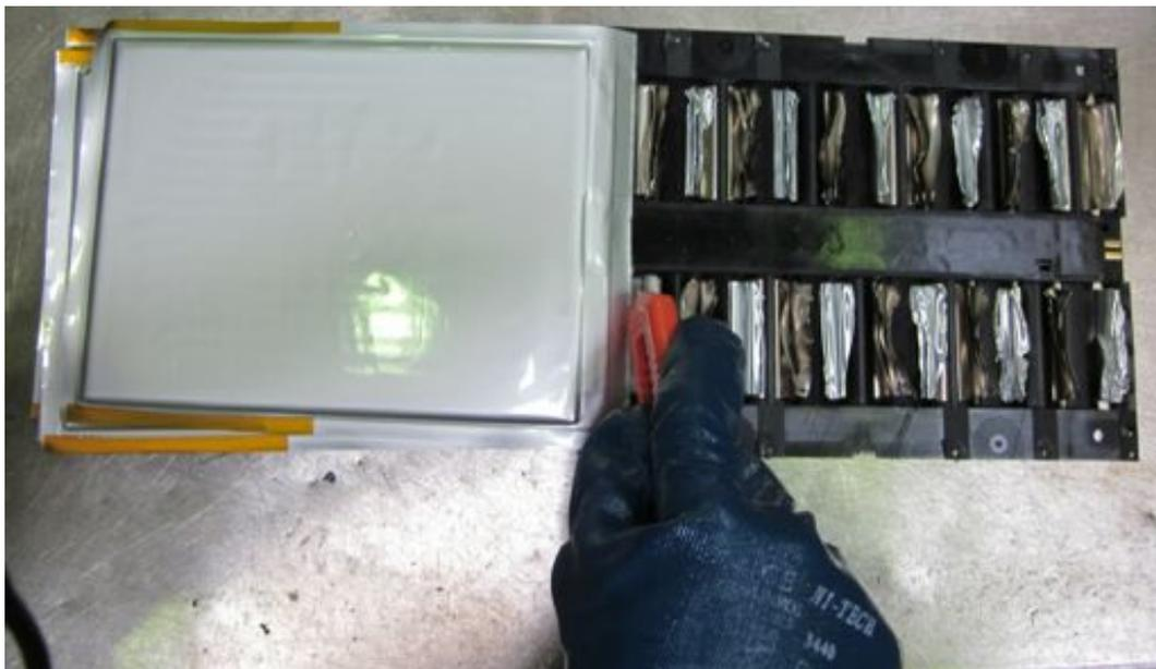
Abbildung 8: Trennung von Batteriezellen und Stromleitern
