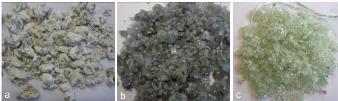
Abbildung 61:  $\text{CaO-CaF}_2$  (a),  $\text{CaO-SiO}_2\text{-MgO}$  (b) und  $\text{CaO-SiO}_2\text{-Al}_2\text{O}_3$ -Schlacke (c)
