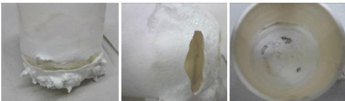
Abbildung 58: Von  $\text{CaO-CaF}_2$ -Schlacke angegriffene  $\text{Al}_2\text{O}_3$ -Tiegel
