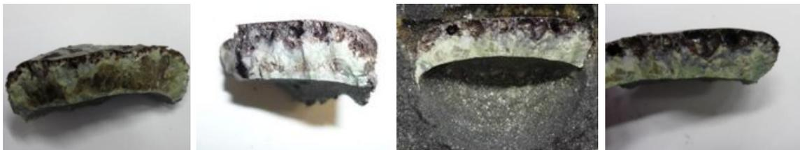
Abbildung 80: Querschnitt durch die entstandenen Schlackenphasen
