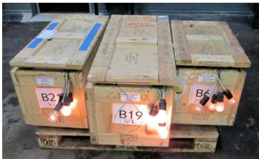
Abbildung 6: Ohm'sche Widerstandsentsladung der Batteriemodule
