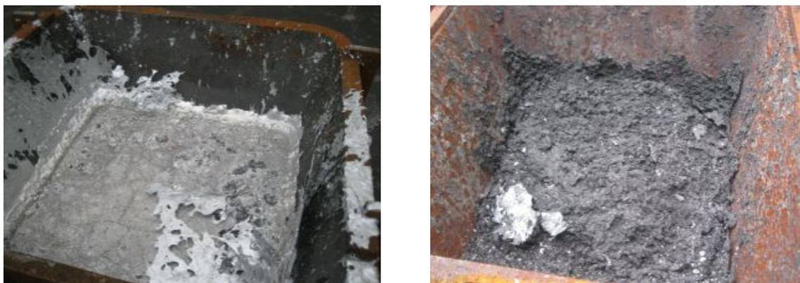
Abbildung 98: Kokille mit dem ersten (links) und dem zweiten Abguss (rechts)
