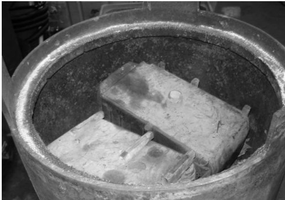
Abbildung 27: Chargenbehälter mit Modulen nach der Behandlung
