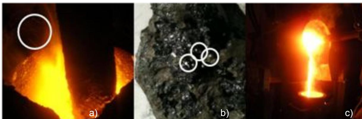
Abbildung 88: Fehlerquellen bei der Metallrückgewinnung während der LBO Versuche: a) Austragung von Material durch Konvektion b) Metalleinschlüsse c) Durchmischung der Schmelze beim Abguss
