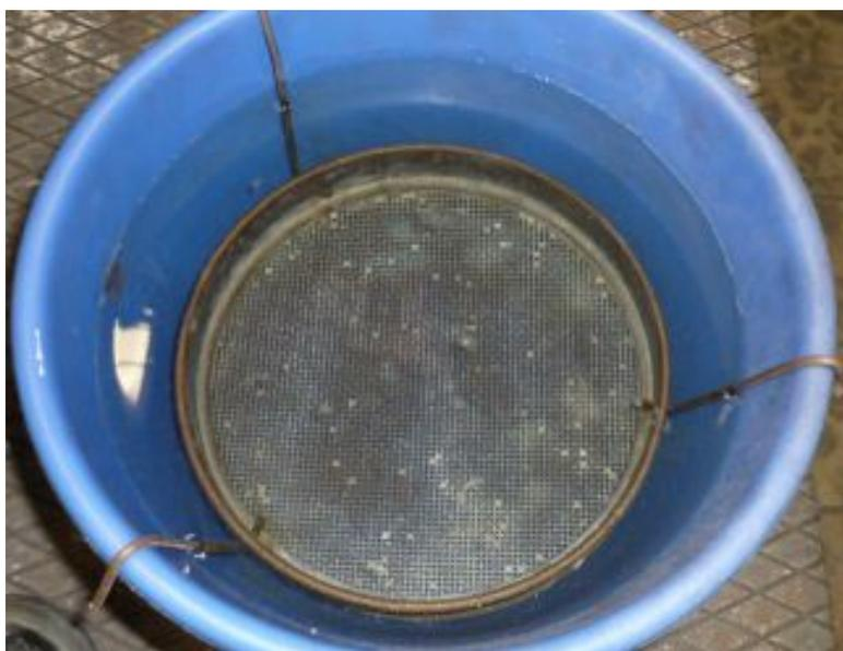
Abbildung 67: Konstruktion zum Auffangen der abgegossenen Schlacke
