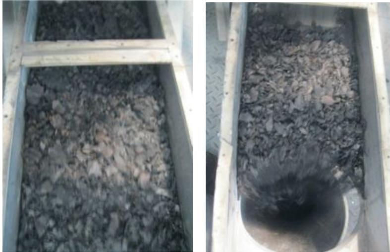
Abbildung 96: Batteriematerial auf Vibrationsrinne
