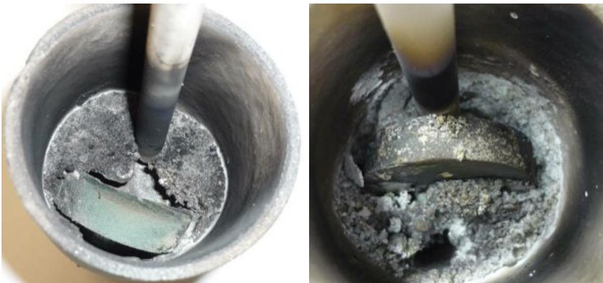
Abbildung 77: Im Vakuum-Induktionsofen nicht komplett aufgeschmolzene Legierung und Schlacke
