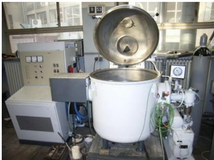
Abbildung 55: Vakuum-Induktionsofen der Firma Balzers
