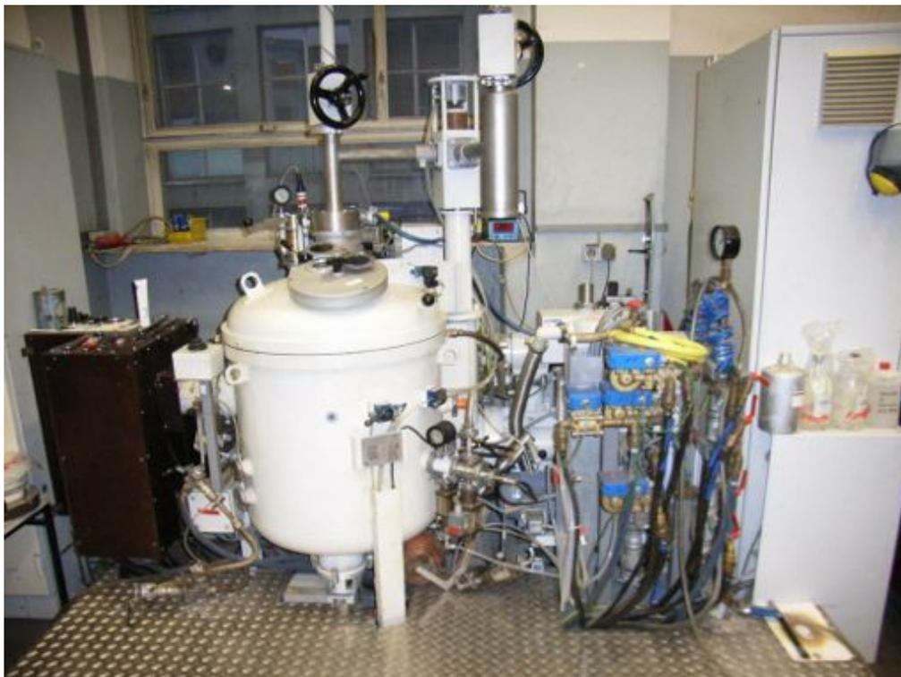
Abbildung 56: Vakuum-Induktionsofen der Firma Pfeiffer Vacuum
