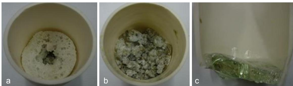
Abbildung 60: Vor (a, b) und nach (c) der Homogenisierung erschmolzene  $\text{CaO-SiO}_2\text{-Al}_2\text{O}_3$ -Schlacken
