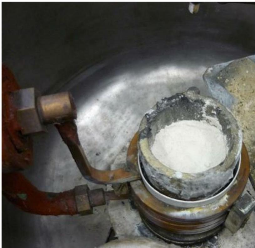
Abbildung 62: Versuchsaufbau zur Schlackenherstellung
