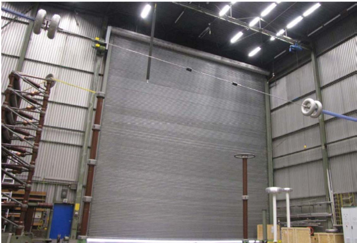
Abbildung 2.3.3: Foto vom Blitzstoßversuch mit zwei auf dem Leiterseil montierten Sensorknoten
