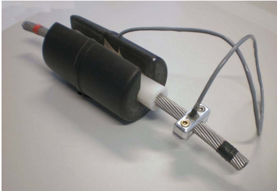
Abbildung 2.5.6: Gehäuse mit Längsschlitz für die Seilmontage
