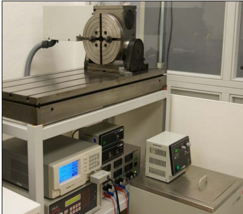
Abbildung 2.3.15: Ansicht des Messplatzes zur Kalibrierung der Neigungssensoren
