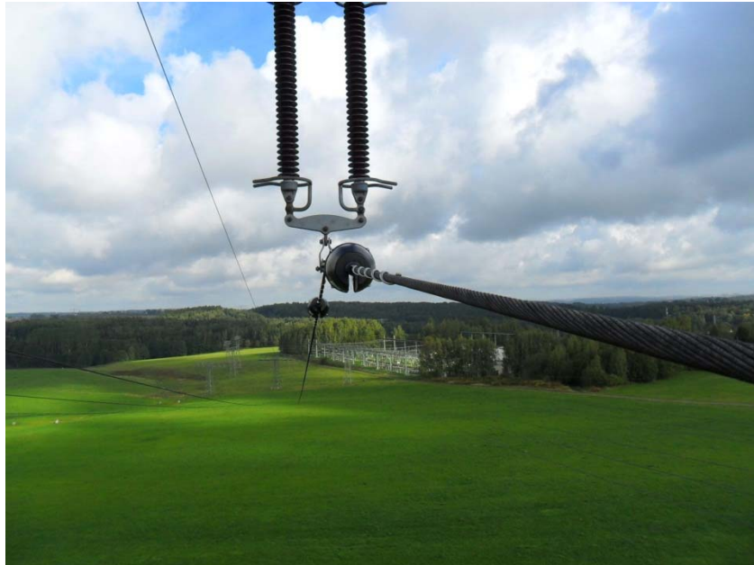
Abbildung 2.3.26: Foto vom Sensorknoten 2 (hinten) und Sensorknoten 3 (vorn) mit Blickrichtung zum Umspannwerk Niederwies
