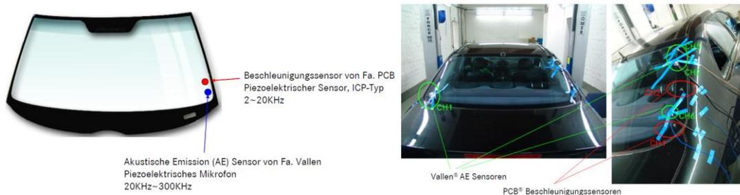
Abb.3 Aufbau der Glasbruchmessung
