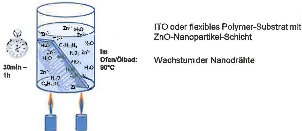
Abbildung 21: Nasschemisches ZnO-Nanodrahtwachstum.
