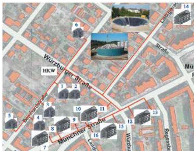
Abb. 5.11: Einbindung der Standard-Wärmespeicher-Modelle in das fiktive Nahwärmenetz 101
