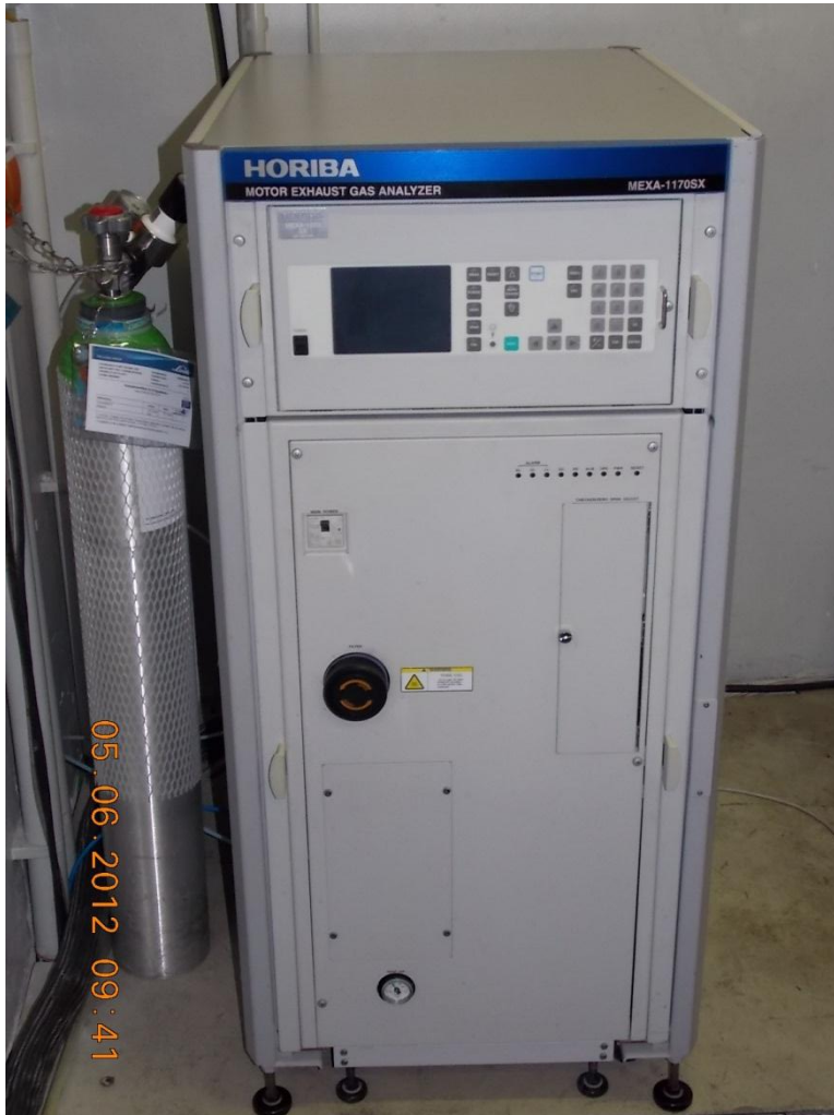
Abb. II-2: H 2 S-Messgerät MEXA 1170SX (Fa. Horiba) für Referenzmessungen
