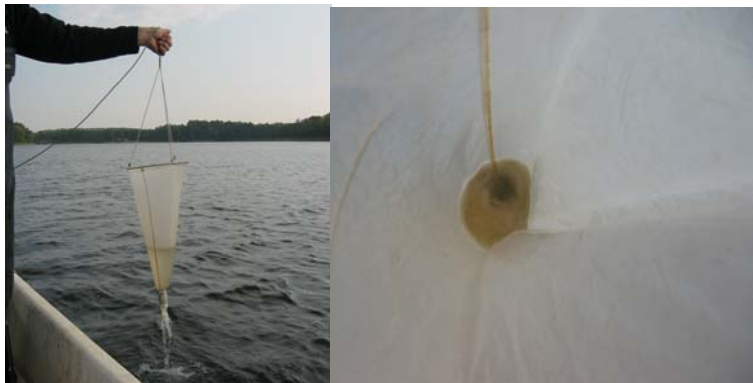
Abb. 2-2. Aufkonzentrierung einer Wasserprobe mittels Planktonnetz (links) und der Blick in das Planktonnetz (rechts).
