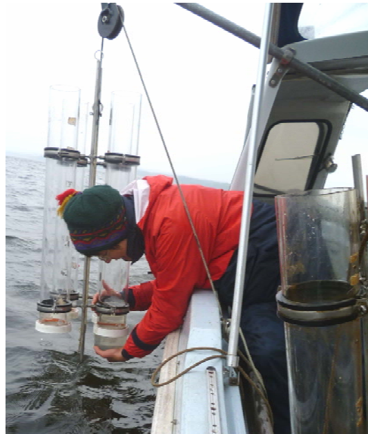
Abb. 2-3. Bergung des Sedimentfallenmaterials, das sich in den abschraubbaren Bechern der Sedimentfallen über 14 Tage gesammelt hat.
