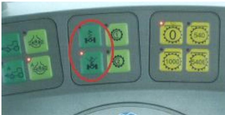
**Abbildung 6.1** - Folientaster zur Betätigung der Vorderachsfederung
