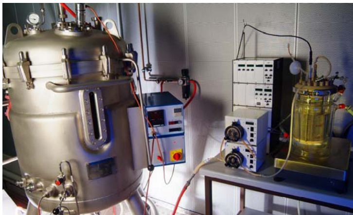
Abb. 7: 1L-Festbettreaktor mit radial durchströmter Schüttung und 150 L-Vorlagetank
