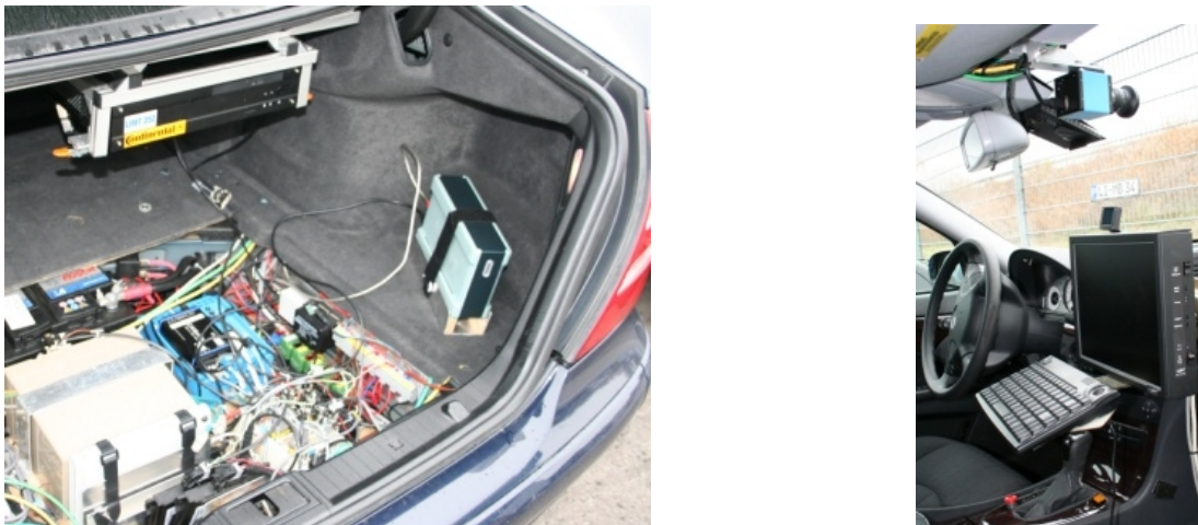
Abbildung 76: Fahrzeugausrüstung: Messrechner, Fzg.-Infrastruktur, Speichermedium (links) und Referenzkamera, HMI (rechts).
