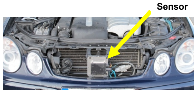
Abbildung 77: Sensorintegration vor dem Kühler.
