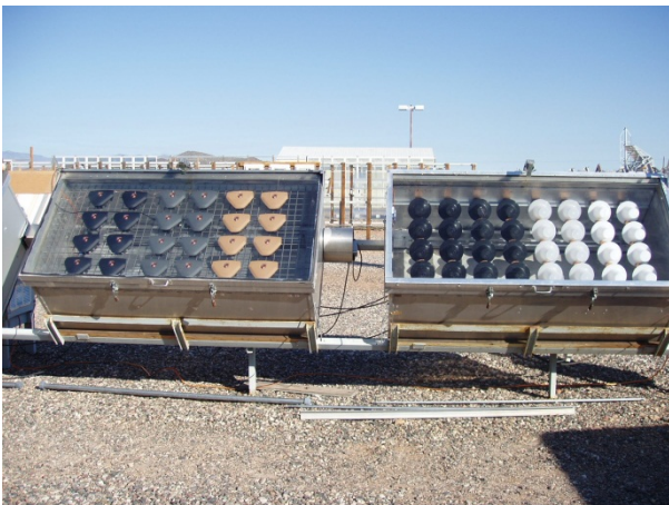
Abb. 6.1.2.1 Freibewitterung in der IP/DP-Box in Arizona und im Fraunhofer ICT
