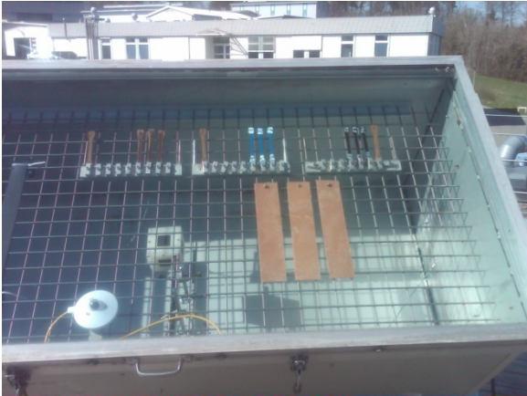
Abb. 6.1.1.3 Kontrollproben der WPC in der IP/DP Box im ICT und in der Freibewitterung
