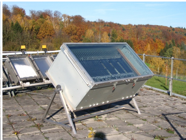
Abb. 6.1.2.1 Freibewitterung in der IP/DP-Box in Arizona und im Fraunhofer ICT
