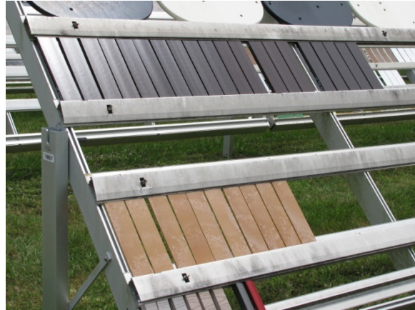
Abb. 6.1.1.3 Kontrollproben der WPC in der IP/DP Box im ICT und in der Freibewitterung
