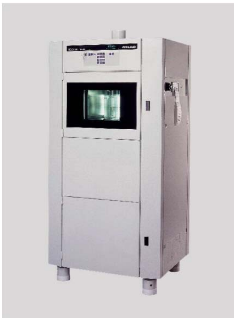
Abb. 6.2.3.1 Xenotest Alpha zur Untersuchung der Reziprozität bei der Rissbildung von naturfarbenem PP
