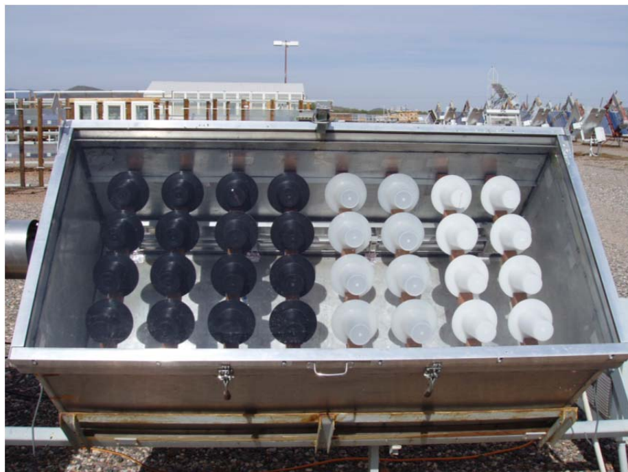
Abb. 6.2.5.1 PP-Hütchen in einer IP/DP-Box hinter Fensterglas unter 45° in Arizona
