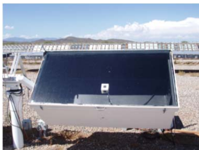
Abb. 6.2.13.3 IP/DP-Box mit Schwarzstandardwürfel
