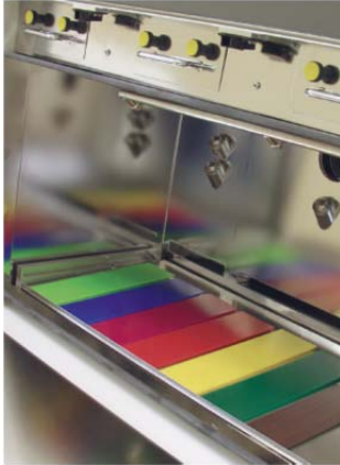
Abb. 6.2.2.1 Flachbettgerät SUNTEST XXL+ zur Bewitterung der WKI Direktbeschichtungen angelehnt an ISO 927-6
