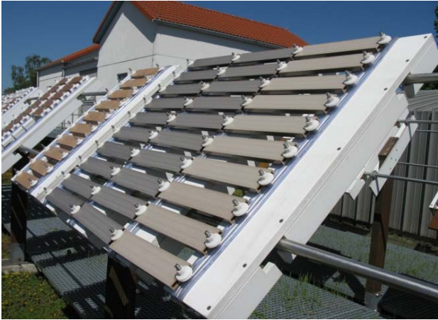
Abb. 6.8.1.3 Bewitterungsstand WKI 2010 – WPC Proben
