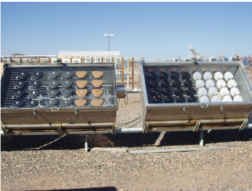
Abb. A1 Versuchsaufbauten zur Messwerterfassung der Oberflächentemperaturen zur Validierung der Simulationsrechnungen (Szenario 1)
