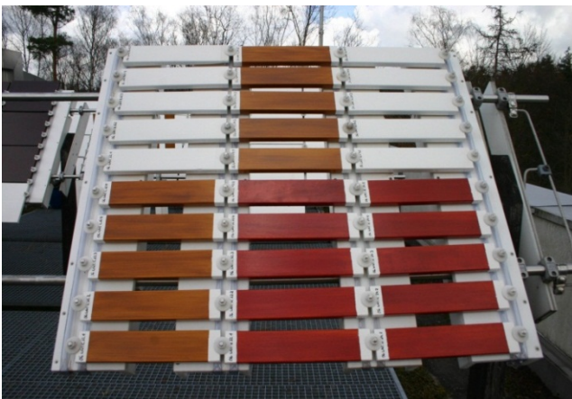
Abb. 6.8.1.1 WKI Bewitterungsstand 2007 – Materialien A, B, C
