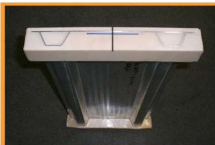
Abbildung 9: Präparation der Stauchproben mit Kunststoffeinspannbereiche, Dehnmessstreifen und Kontrastspray-Oberfläche für die stereoskopische 3-D-Verformungsmessung.
