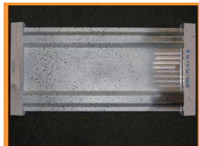
Abbildung 9: Präparation der Stauchproben mit Kunststoffeinspannbereiche, Dehnmessstreifen und Kontrastspray-Oberfläche für die stereoskopische 3-D-Verformungsmessung.
