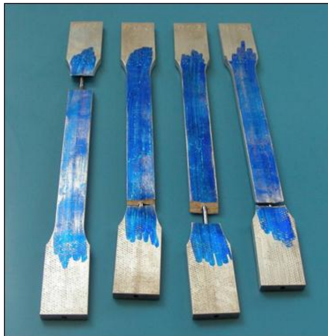
Abbildung 33: Getestete Zugproben; wegen zu großer Drahtdurchführung der Strangpressmatrize zu geringer Lastübertrag auf den Draht.
