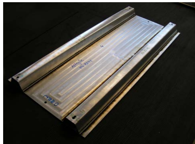
Abbildung 8: Hervorragende Laserstrahlschweißnahtausbildung (Oberraupe) nach dem beidseitig-gleichzeitig Schweißen & Laser geschweißte 2-Stringer-Stauchprobe.
