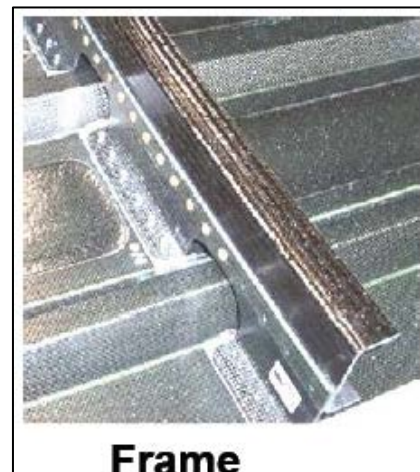
Abbildung 24: Differential aufgebauter CFK-Spant in der Boeing B787.
