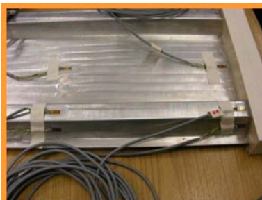
Abbildung 9: Präparation der Stauchproben mit Kunststoffeinspannbereiche, Dehnmessstreifen und Kontrastspray-Oberfläche für die stereoskopische 3-D-Verformungsmessung.
