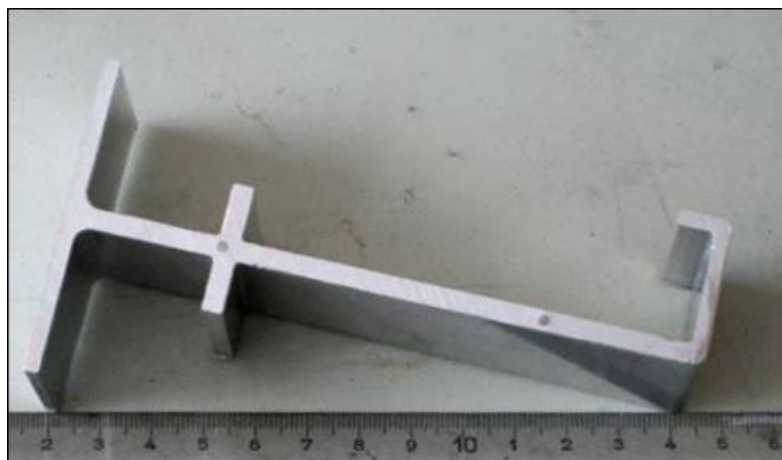
Abbildung 32: Draht in Mittelgurt wegen nicht optimierten Masseflusses nach unten verschoben.
