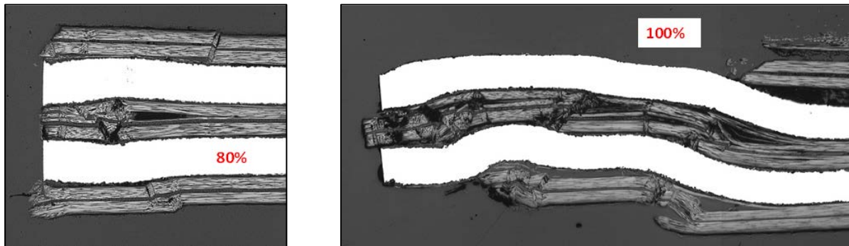
Abbildung 15: Versagensverhalten von HTCL bei 80 bzw. 100 % statischer Festigkeit.
