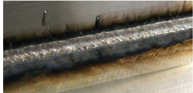
Abbildung 7: Beidseitig gleichzeitiges Laserstrahlschweißen von Hut-Stringern.
