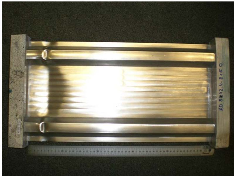
Abbildung 10: Hut-Stringer-Stauchproben des Werkstoffs EN-AW5xxx.
