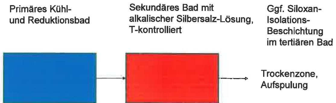
Die Verweilzeiten sind durch Umlenkung der Fasern innerhalb der Bäder einzustellen.
