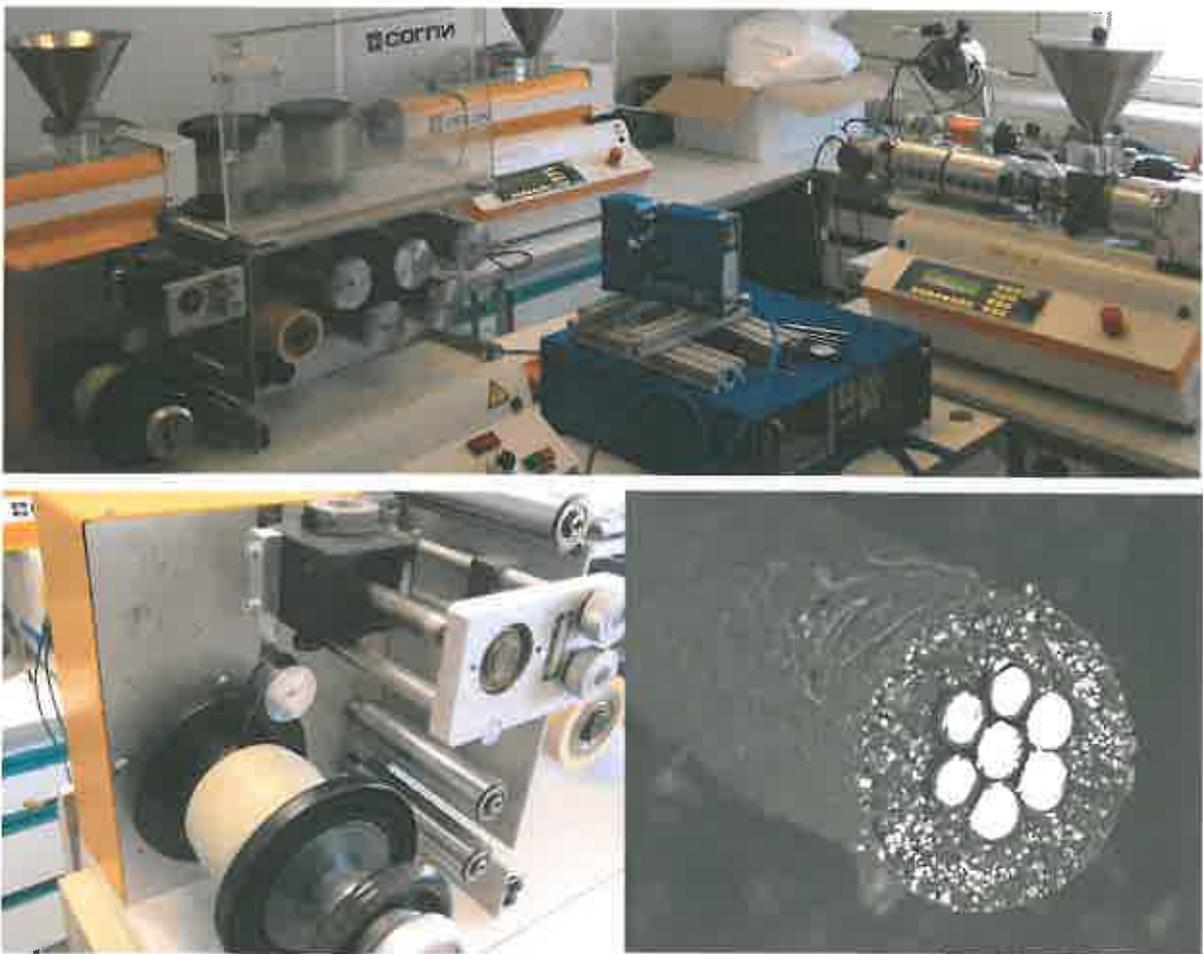
**Bild 6: Ummantelung im Prototypenmaßstab**
