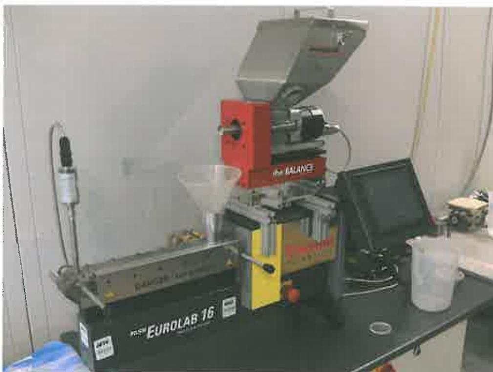
**Bild 8: Laborcompoundierung mit paralleler Doppelchnecke am ITV /1/**
