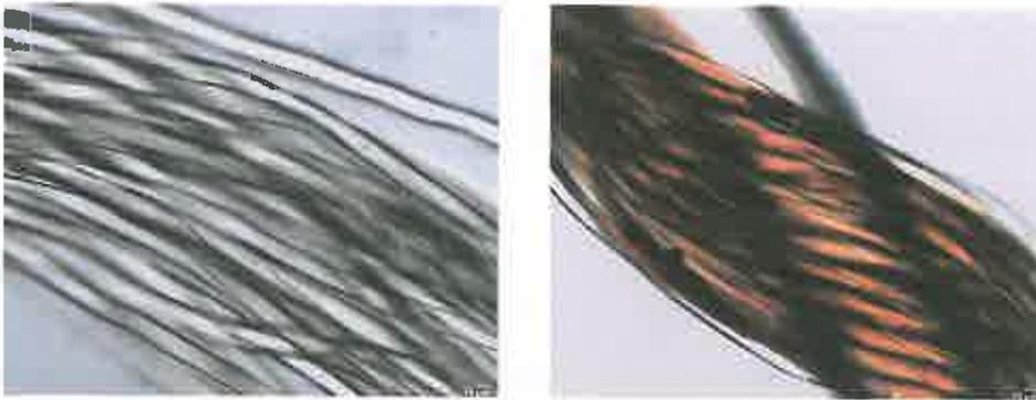
Durchlicht-Mikroskopie an einer Polyester-Probe. Links unbeschichtet, rechts Nano-Ag beschichtet. Die Fasern besitzen eine Oberflächen-Leitfähigkeit in der Größenordnung der metallischen Volumen-Leitfähigkeit (Widerstand nahe 0 Ohm)
