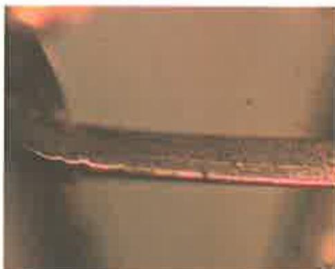
Mikroskopische Aufnahme (Auflicht-Mikroskopie) von PA, Ag-beschichtet.
