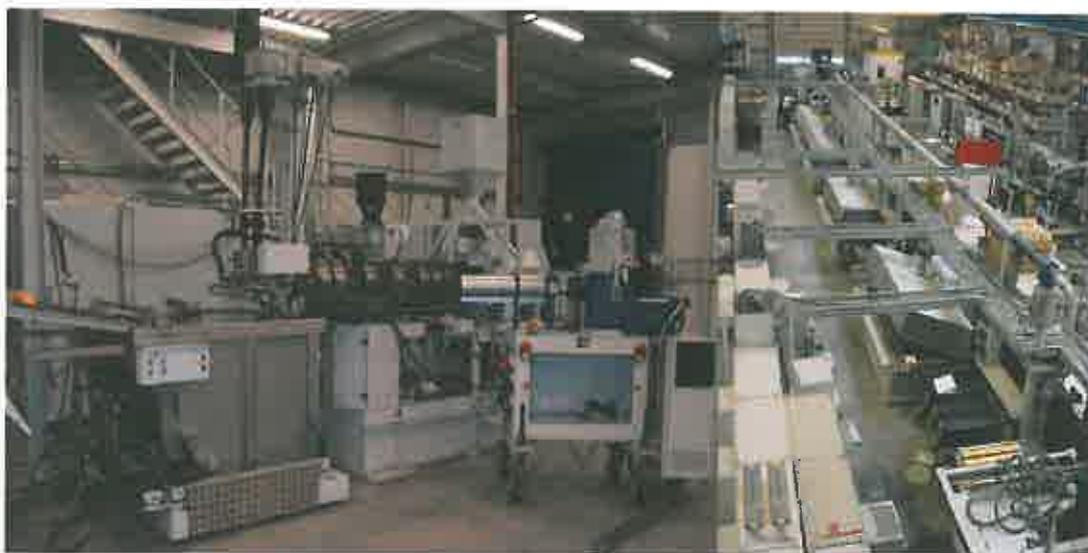
**Bild 29: Labor- Monofilamentanlage für die verfahrenstechnische Entwicklung**
