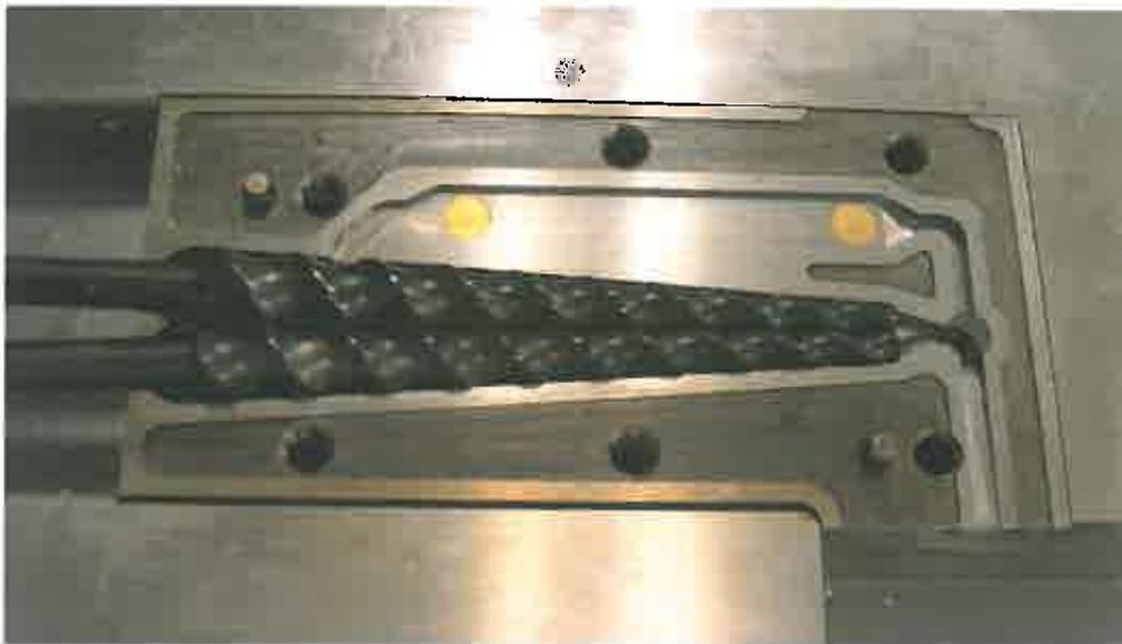
**Bild 7: Laborcompoundierung mit konischer Doppelchnecke am ITV mit geöffnetem Gehäuse /4/**
